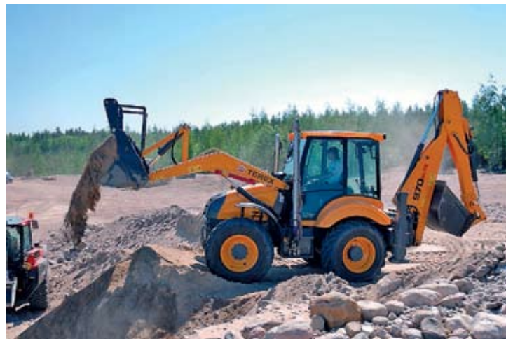
↑ Terexin kauhassa kulki mittausjakson aikana kaikkein vähiten hiekkaa. 20 kauhalliseen mahtui 22 t, ero suurimman määrän kantaneeseen Länkkäriin (76 t) on suuri.
