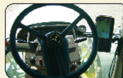
Ajopylväseen asennettu ohjausyksikkö sekä näytetty ohjauspyörän oikealla puolella.
