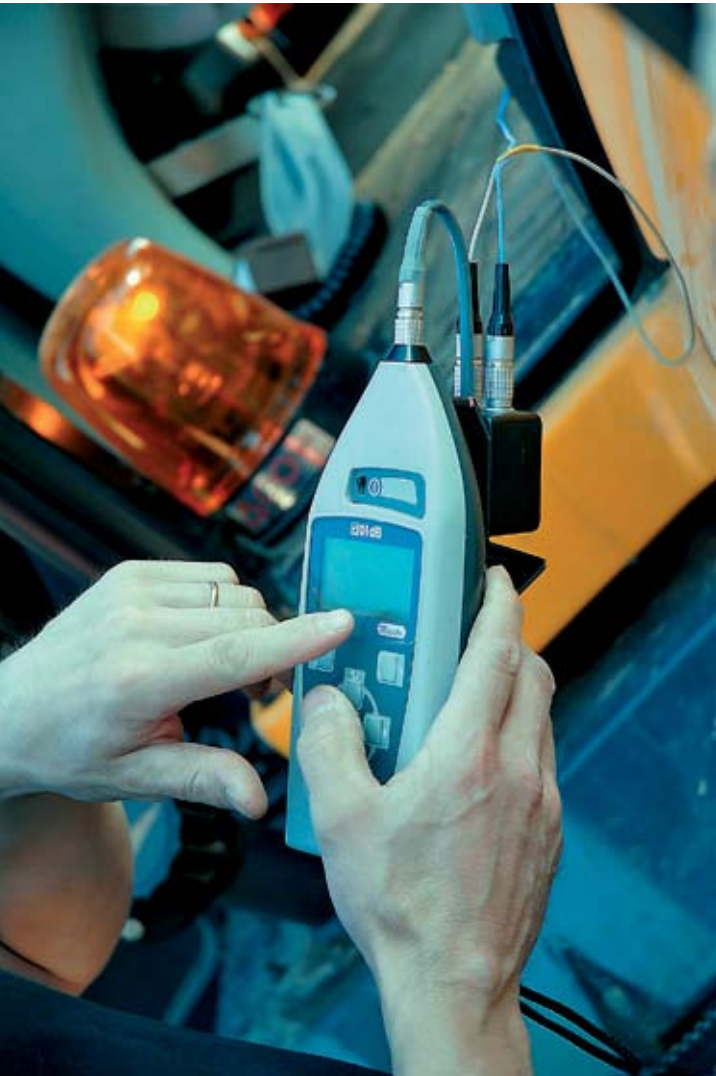
Mittaukseen käytettiin 01dB:n Maestro käsimittaria.
