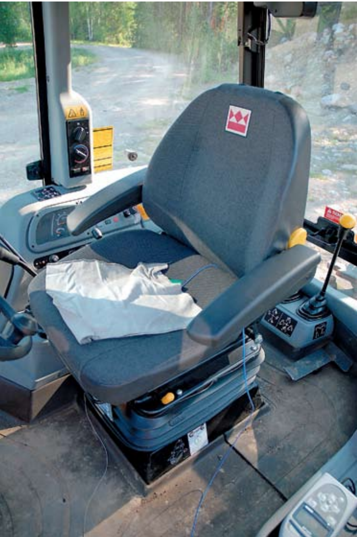
Tärinäanturi kiinnitettiin kuljettajan takapuolen alle mittauksen ajaksi.
