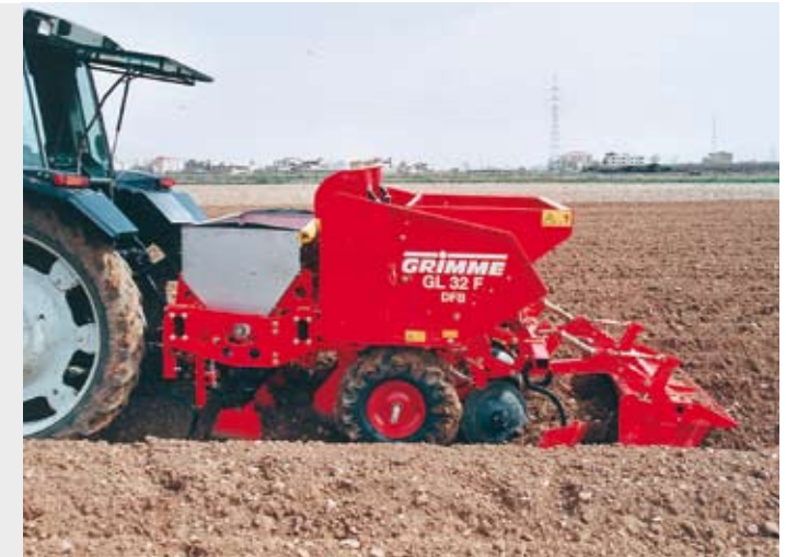
Grimmen uudistetut istutuskoneet voidaan varustaa myös lannoitesäiliöillä (JV).
