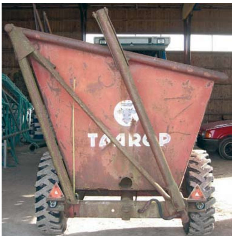
Vesikärryn perustana käytettiin sivullekipaavaa Taarup-rehuvaunua.
