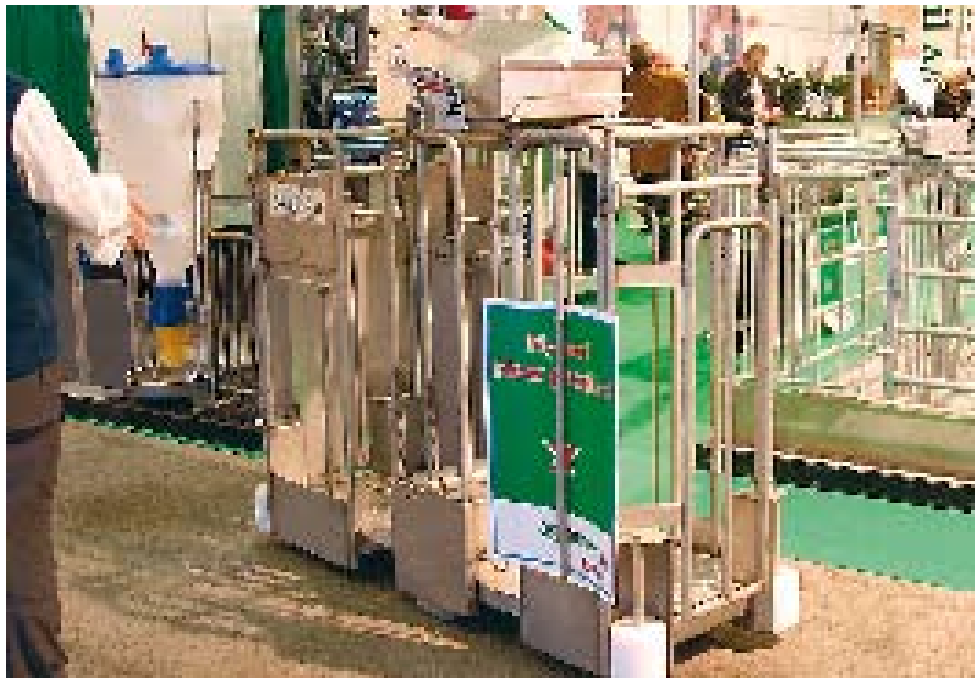
Karjukärri kuljettaa karjaa tiineytysosaston etukäytävällä sika-lanhoitajan ohjauksella laitetta kaukosäätimellä.
