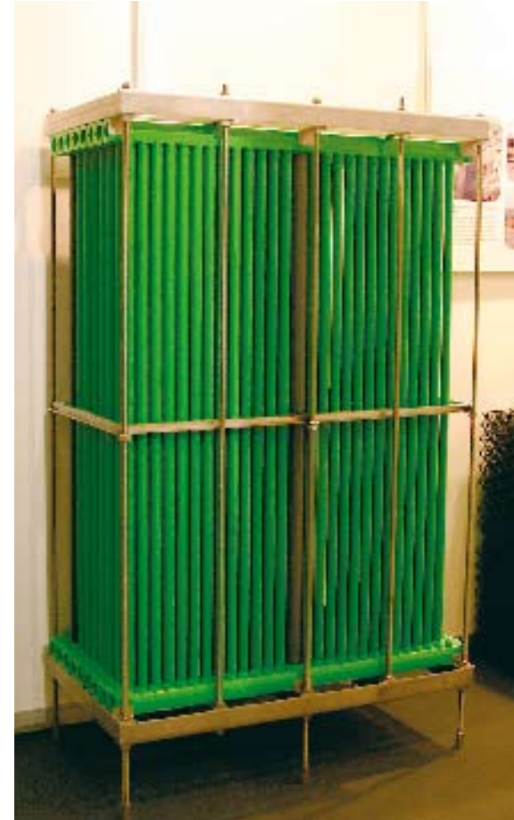
Vesi kiertää maaputkista lämmönvaihdinyksikön putkiin ja korvausilma otetaan yksikön lävitse sikalaan.
