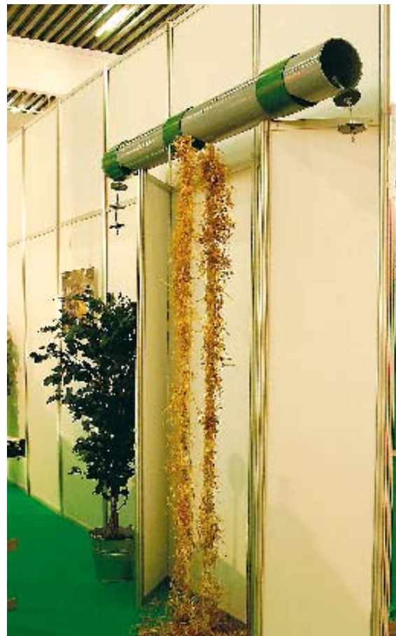
Kuivitettava karsina tai parsi voi sijaita jopa sadan metrin päässä olkisilppurista. Sykloni erottaa enimmänsä pölyt ennen jakoputkistoa.
