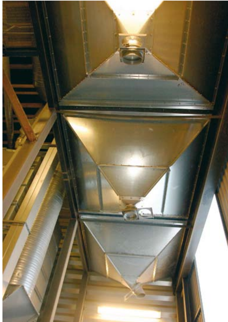
Kaatosuppilo vetää 48 kuutiota, puskurisiiloja täytyy hiukan korottaa, jotta kuhunkin mahtuisi kuivurillinen viljaa.
