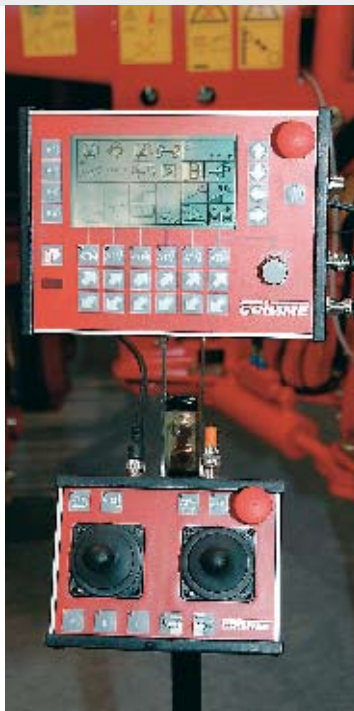
Ohjausyksikkö on samanlainen kuin kaksirivisissä malleissa ja tarjoaa ohjaajalle paljon enemmän informaatiota kuin pienempien yksirivisten mallien ohjauskonsolit (JV).
