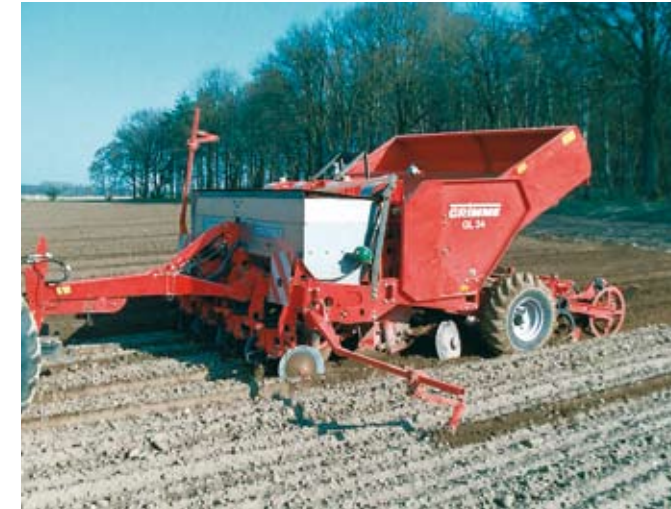
Grimmen uudistetut istutuskoneet voidaan varustaa myös lannoitesäiliöillä (JV).
