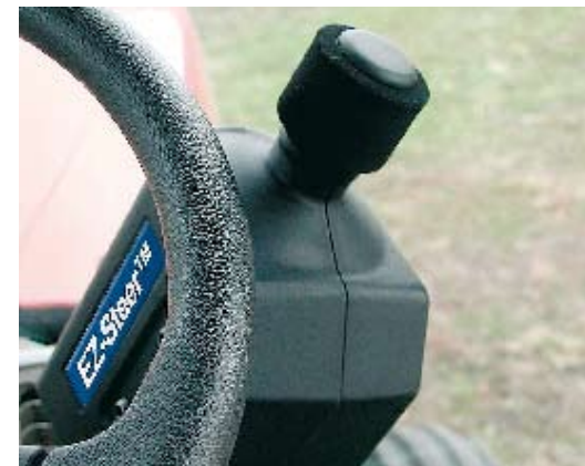
AGLeaderin EZ-Steer-rissa GPS:n ohjaa- ma sähkömoottorin kitkarulla pyörittää ohjauspyörää. Kuva: Agromek.
