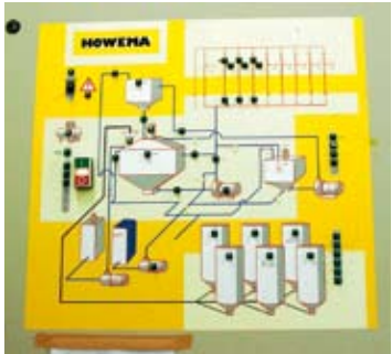
Liemiruokkijan ohjauskaapin kansi on valotaulu, joka näyttää menos- sa olevan prosessivaiheen.
