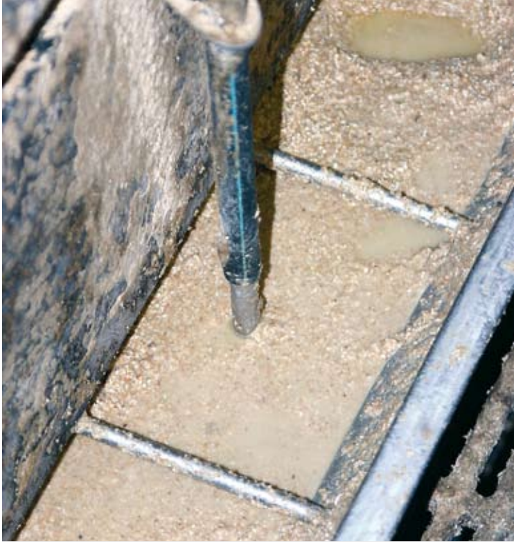
Seos on puuromaista, eikä se saa lajittua kaukalossa. Sekä vilja että soija jauhetaan 3 mm:n seulalla.
