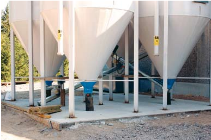
Rehusiilojen ruuvit tuovat rehua yhteiselle U-ruuville, joka kuljettaa rehun sikalaan ja pudottaa sen liemiruokkijan säiliöön.
