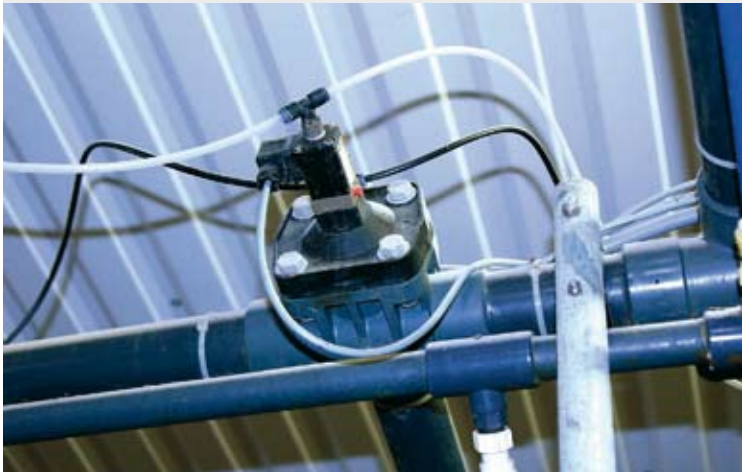
Paineilmalla toimiva kalvoventtiili hidastaa rehuannoksen syöttöä loppuvaiheessa. Tavoitteena on tarkempi jako ja hiljaisempi toiminta.
