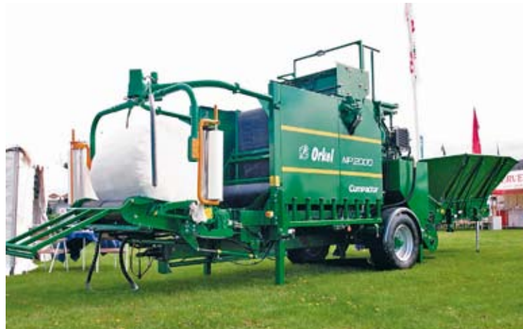
Orkel MP 2000 Compactor on tarkoitettu erilaisen irtotavaran paalaukseen: kutterinlastu, puumurske, komposti, turve, muovi, vilja, maissi. Sähkö- tai traktorikäyttöisenä, tehontarve 90 kW. – Orkel Compaction AS ( www.orkel.no ).
