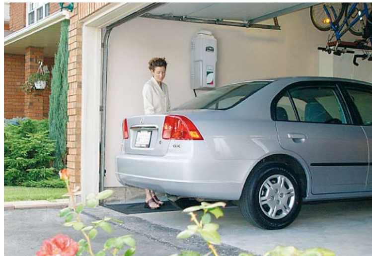
Auton tankkiin biokaasu paineistetaan maksimissaan 200 bariin. Tankkaus aika on noin 3–5 minuuttia. Kaasun hidastankkauslaitetta myydään Yhdysvalloissa noin 2000 dollarilla. Se sopii hyvin myös puhdistetun biokaasun tankkaukseen. Yön yli tapahtuneen tankkauksen jälkeen auto on aamulla lähtövalmiina.
