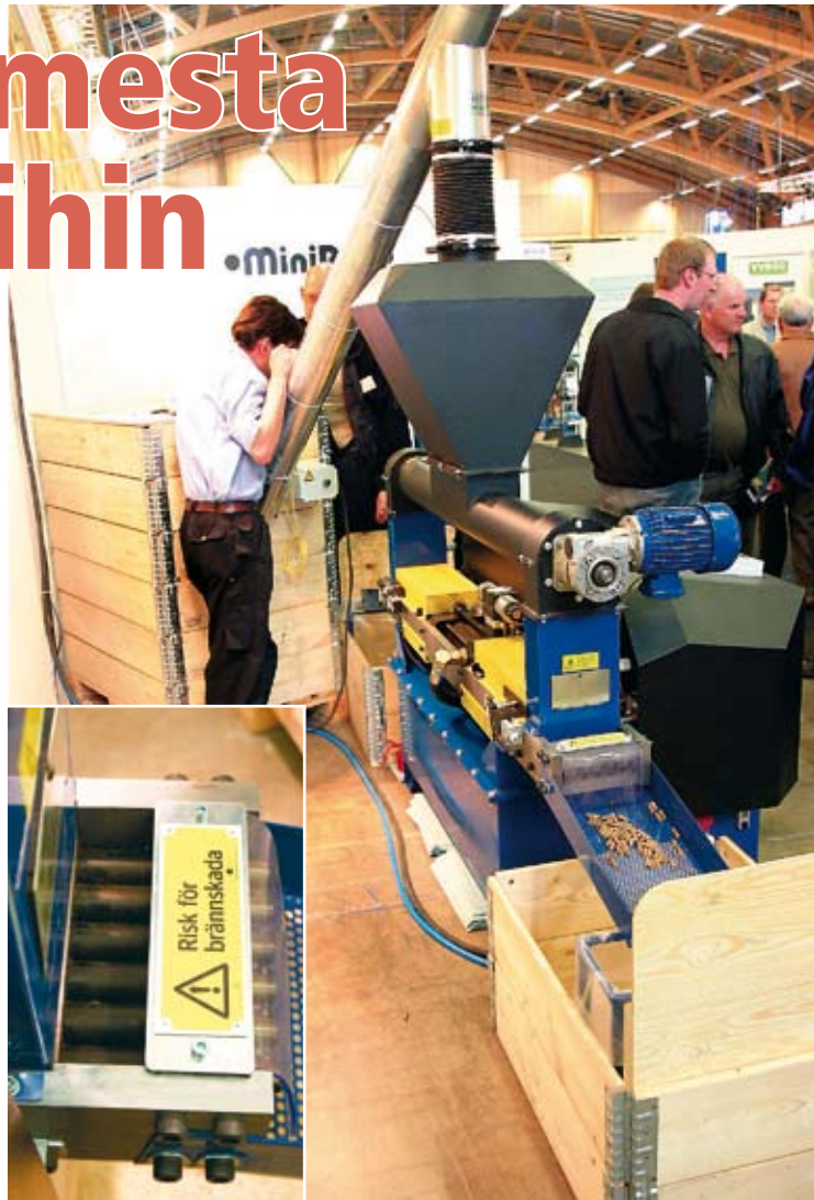
MiniPell-puristimen tekniikka perustuu suulakepuristukseen. Raaka-aine valuu syklonista kaksoisruuvikuljettimelle, joka syöttää sen paineilmatomisten mäntien eteen. Ne työntävät raaka-aineen laitteen kahden puolen olevaan viiteen suulakkeeseen, joiden syöttöpään läpimitta on 16, ulostulopään 8 millia. Kone toimii 7,5 kW:n sähkömoottorilla.
