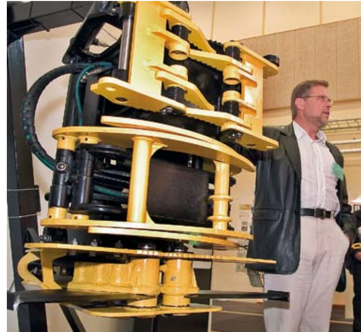
Henry Carlsson sanoo kehittäneensä ensimmäisen ruotsalaisvalmisteisen keräävän energiapuukouran. Harvesterin puomiin asennettavan kouran paino on 500 kiloa ja sillä yksittäin katkaistavan rungon läpimitta voi olla 25 senttiä. Katkaisuun on giljotiiniterät. Kouran öljyntarve on 80 l/min, työpaine on 20 MPa. Kuva: Elmia
