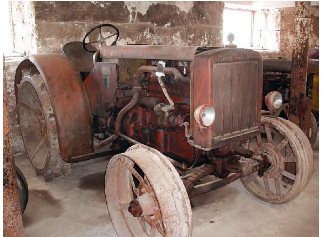
Jatkosodan aikana Suomeen saatiin vain saksalaisia traktoreita, merkit olivat yleisyysjärjestyksessä Lanz, Hanomag ja Deutz. Kuvan Hanomag R 40 vuodelta -43 oli sen ajan koneeksi valtavan suuri, painoa 3400kg. 4-sylinterisen dieselin tilavuus oli 5,2 litraa ja tehoa löytyi 40 hv 1200 kierroksella.
