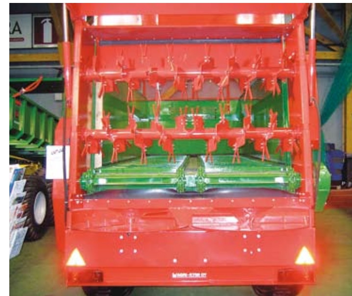
Tarkkuuslevittimen murskauskelat jauhavat olkisen ja paakkuuntuneen lannan hienojakoiseksi massaksi. Kelojen takana oleva ohjauslevy pudottaa massan lautasille, jotka levittävät lannan tasaisesti ja leveälle. Herkuleksessa kelojen takana oleva ohjauslevy, eli käytännössä koko vaunun takaseinä, voidaan avata hydraulisyntereillä huoltoon ja puhdistusta varten. Säätöportti on kuvassa kokonaan auki.
