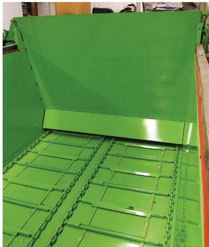
Tytan-levittimien pohjakuljetin on kaksiosainen. Tytan 14 mallin kuormatilan pituus on vinon etulaidan keskeltä säätöporttiin mitattuna 380 cm, suuremmissa Tytan 18 mallissa lava on puoli metriä pitempi. Säätöportti on kuvassa suljettuna eli kuljetusasennossa.
