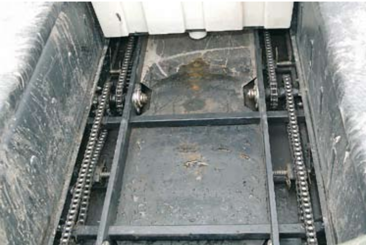
↓ Voimansiirto on hoidettu ketjuilla. Näkyvissä on myös runkorakennetta. Alapuolella on kaksisopohja.
