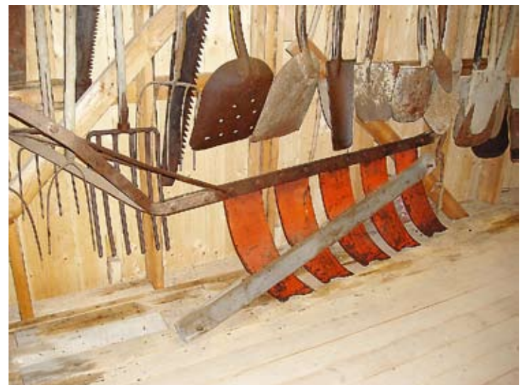
Entisajan karjataloudessa tarvittiin lämpimänä aikana runsaasti jäätä maidon jäähdytykseen ja jäiden otossa jääkarhusta oli uskomaton apu. Hevosvetoisella laitteella höylättiin railot, jotka muuten olisi pitänyt avata tuurala tai sahata käsikäyttöisellä jäsahalla. Railoa ei avattu kerralla pohjaan asti, sitä varten jääkarhussa oli erilliset säätölaudat.
