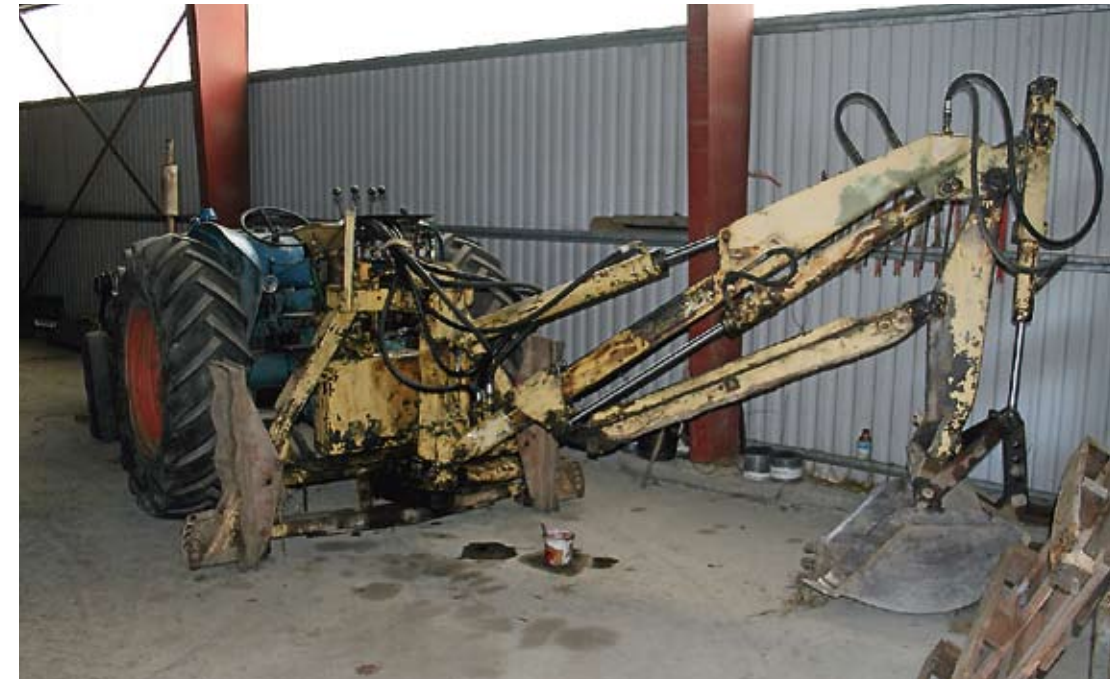
Hydro-Master oli Lännen Tehneiden konepajan ensimmäinen traktorikaivurimalli, myöhemmin merkiksi vaihtui Ukko-Mestari. Hydro-Master kiinnitettiin suoraan traktorin vetovarsiin, koska mitään kiinteitä asennuksia ei tehty, oli kaivuri helppo irrottaa ja käyttää traktoria muissa töissä.
