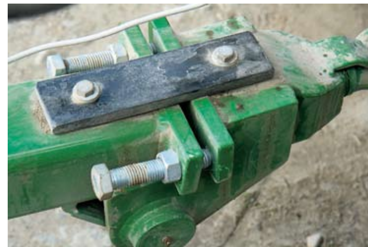
↑ Kivipecan säädettävä puominivel piti lukita rautapalkilla, koska perään liitetty joustopiikkiäes vähensi ratkaisevasti aisapainoa.
