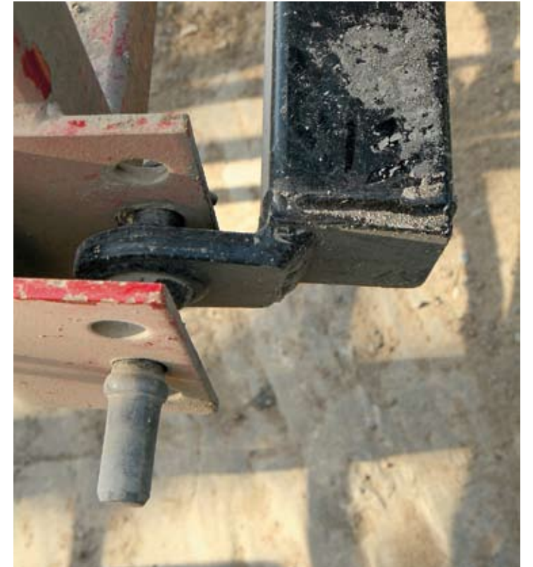
↑ Vetokartun päät on tarkoitus muuttaa teleskooppisiksi, jolloin perään voisi kytkeä muitakin työkoneita.
