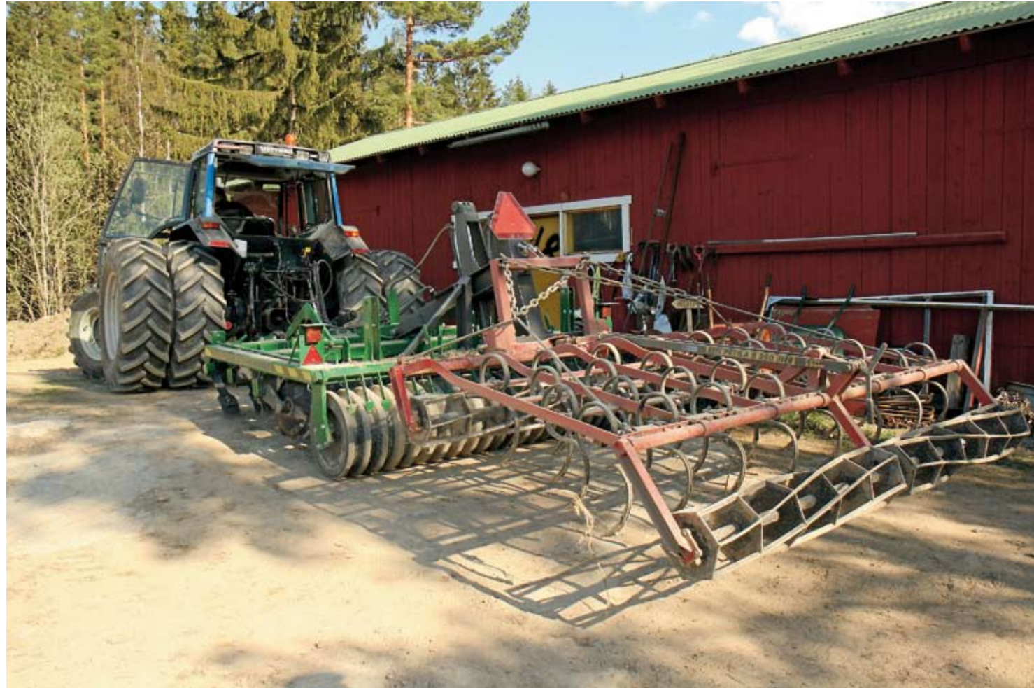
↑ Potila ylös, Kivi-Pekan lautaset ylös ja menoksi. Yhdistelmä rullaa pehmeästi lautasäkeen kumipinnoitteen umpikumpakkerin varassa.
