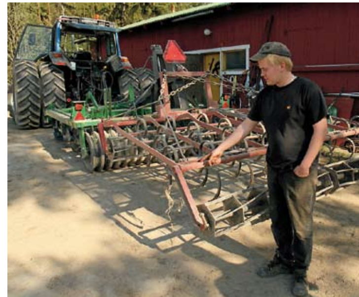
↑ Tähän pitänee asentaa takavalot, sillä kuljetusasennossa Potila peittää Kivi-Pekan perävalot, näyttää äesyhdistelmän isä, Ville Vierika.
