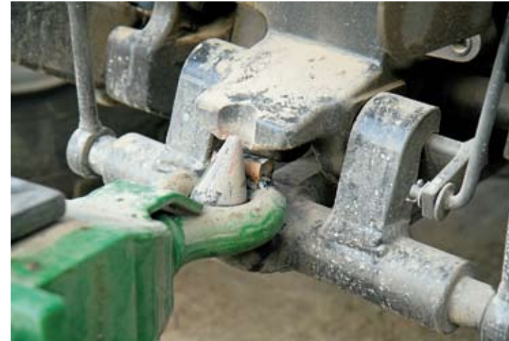
↑ Vetosilmukkaan hitsattu korokepala estää silmukan ylös-alas hakaamista vetokoukussa.
