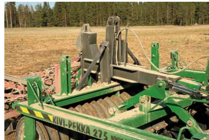
↑ Muutostyö on tehty laadukkaasti. Painoa lisärungolla kertyy arviolta 300 kiloa.
