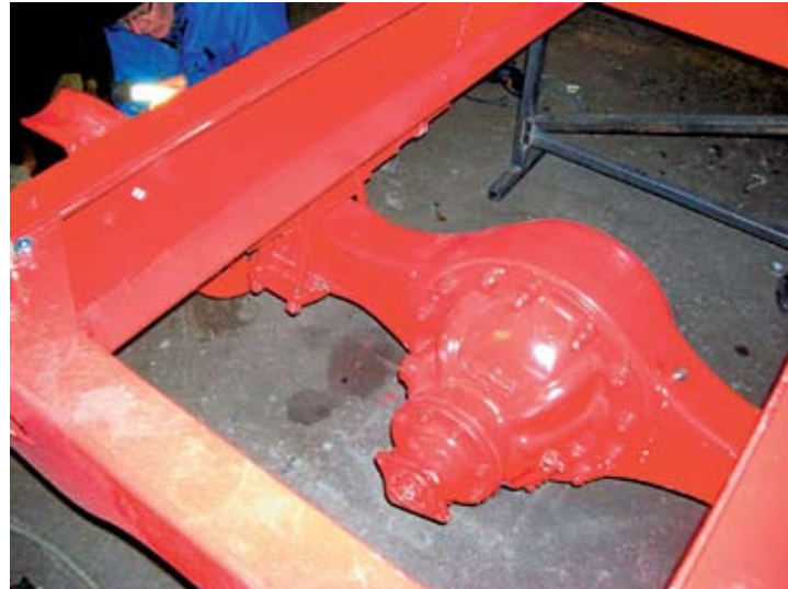
↑ Esa asentaa vetoakselia. Huomaa perään sorvatut uudet pulttit.
