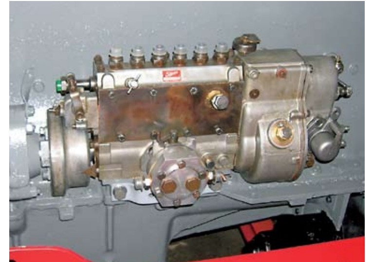
↑ Dieselmiehet ovat huoltaneet syöttöpumpun. Kunnossa on!
