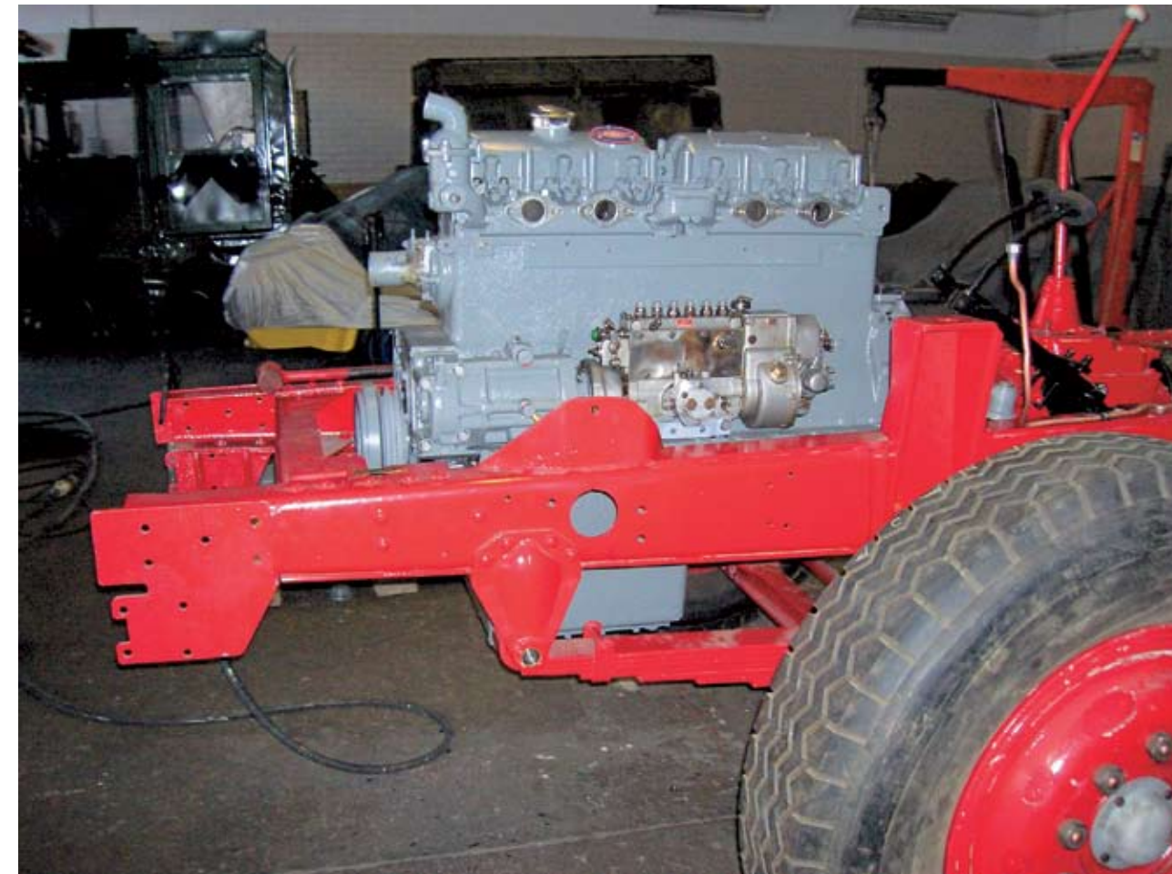
↑ Taas askel eteenpäin. Pyörät alla, moottori ja vaihteisto paketissa.
