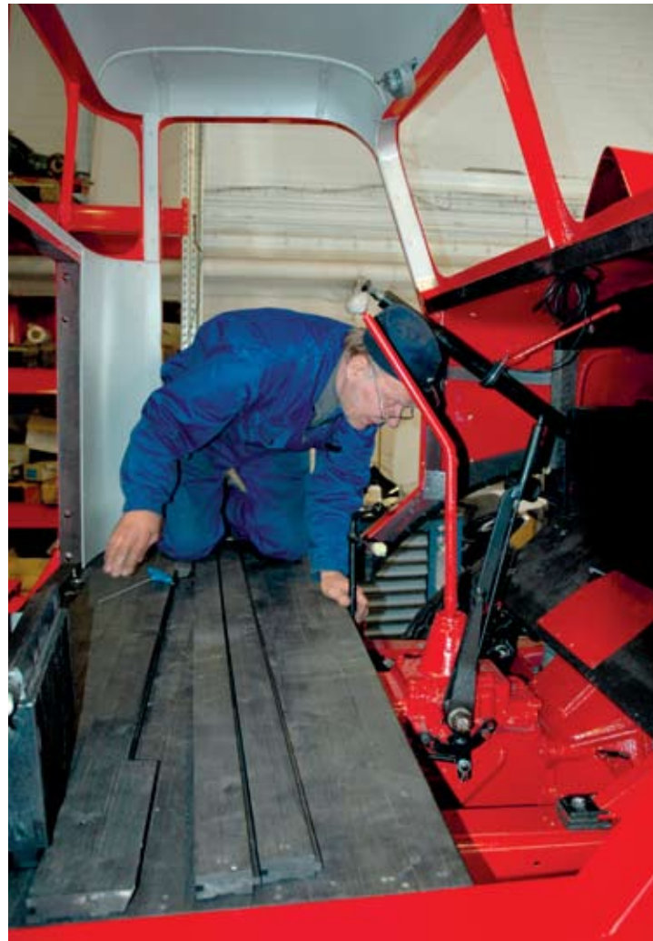
↑ Koneistamomies taipuu välillä puusepäksi, kun ohjaamon lattiaa rakennetaan.
