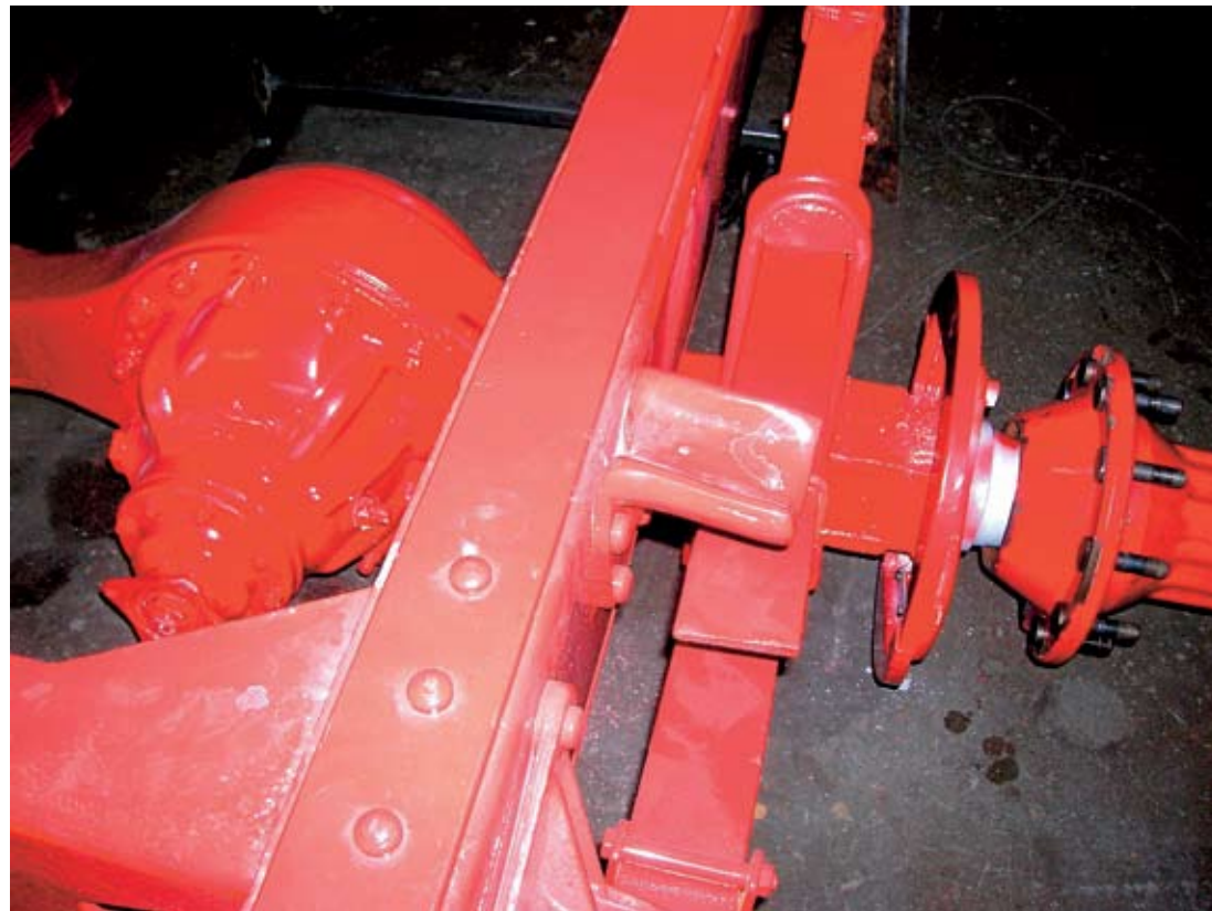
↑ Uudelleen laakeroitu taka-akselisto odottaa jarrujen asennusta.
