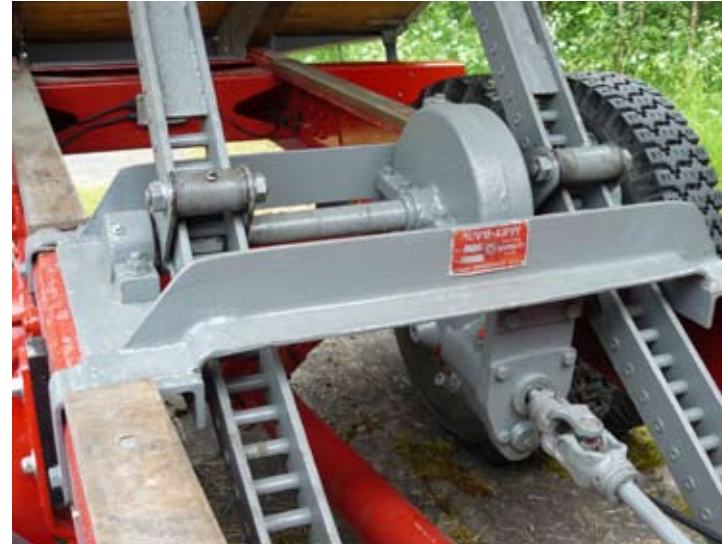
↑ Alkuaan peltimutteriin ja kuuliin perustunut kipin vetomurros korvattiin tavallisella yleismallin ristikkoniveellä.
