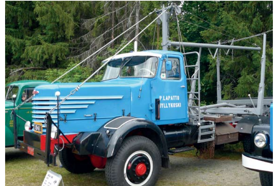
Tässä Vanajassa on tukinajovarustus. Alusta on nelivetoinen VKN2-4300, moottori AEC AV470 (teho 135 hv). Vuosimalli on 1960.
