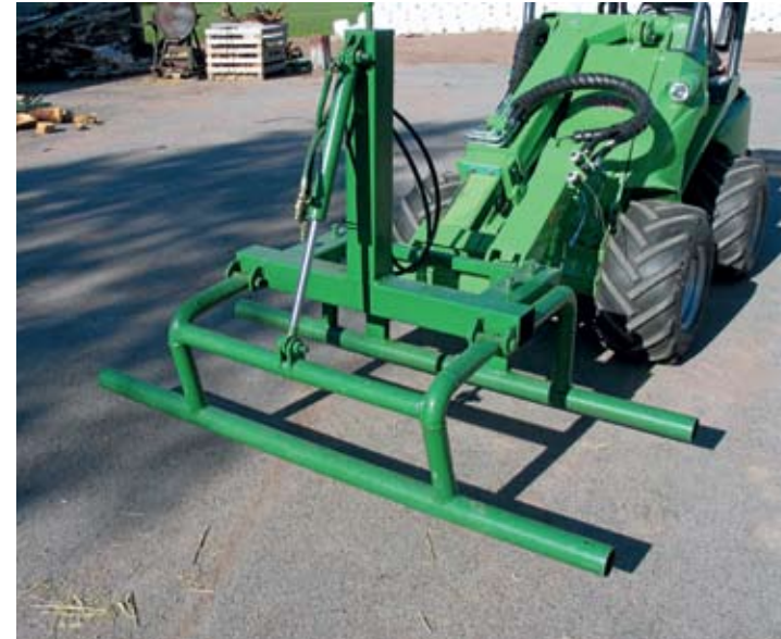
↑ Juha Parkkila on itse kehittänyt ja valmistanut myös paalipihdin, joka nostaa kerralla neljä paalia.
