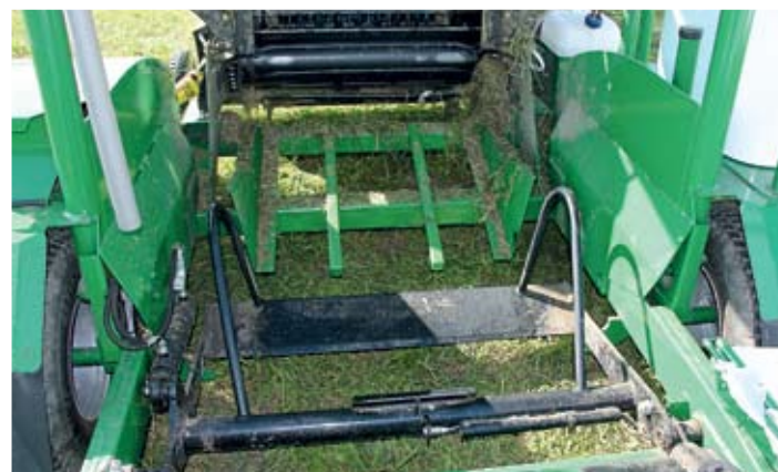
Midin palaukammio on 85 cm leveä, ja siinä on 7-teräinen silpuri.
