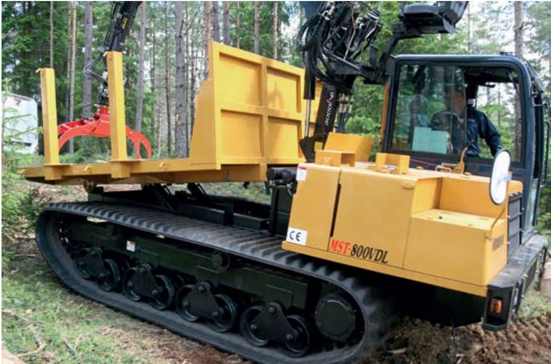
Japanilaisen Morooka MST-800 VDL:n näytöskuski oli varmasti yksi messujen ahkerimmista. Kone pyöri rinnereitillä lähes tauotta. Koneessa on kumitelat ja keulavinssi. Kuormaamista varten kuskin on tultava ulos ohjaamosta nosturin tuolille. Nosturi oli Hiab. Kuormatila ei ollut suuren suuri. Toispuoleisen ohjaamon ansiosta pitkiä pöllejä voi kuormata etusermin ohi, kunhan lyhyitä on ensin lastattu pohjalle. Koneen leveys oli 2,38 metriä ja kokonaispituus 5,07 metriä. Tämän toiseksi suurimman mallin moottorissa oli tehoa 81 kW. Kokoluokkia on kaikkiaan 6 kpl samalla runkorakenteella.
