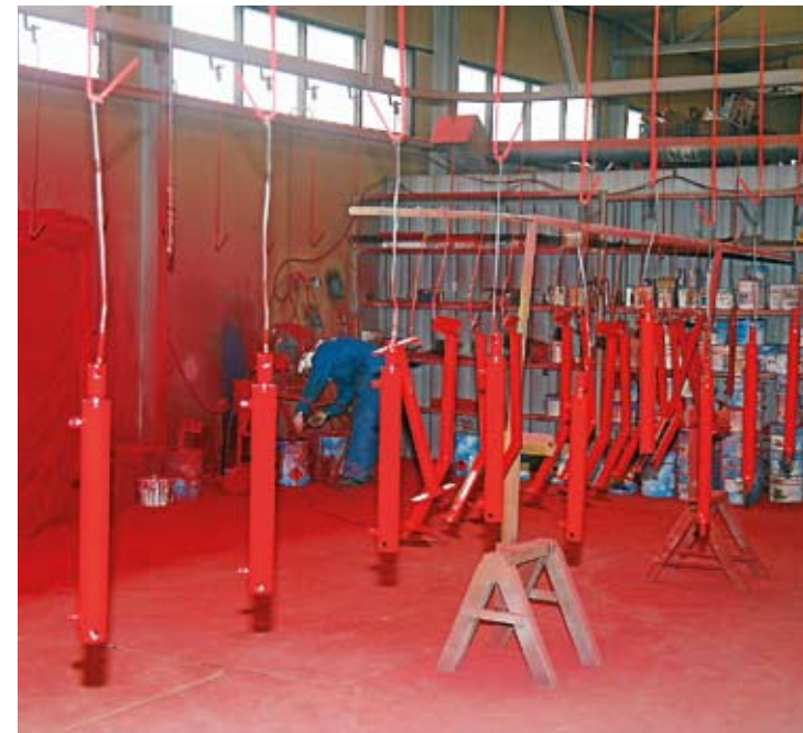
↑ Kaikki metalliosat joko sinkitään tai maalataan uretaanimaalilla korroosion estämiseksi ja puhtaanapidon helpottamiseksi.
