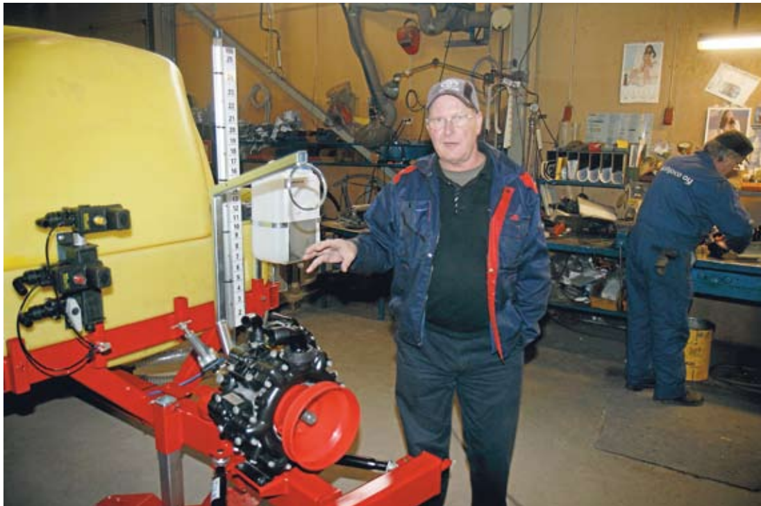
↑ Puolihydrauliset pumput ovat Kasi-ruiskujen sydän. Pumpun kalvoa liikuttaa öljy mekaanisen tangon asemasta, mikä lisää kalvojen kestoikää huomattavasti.
