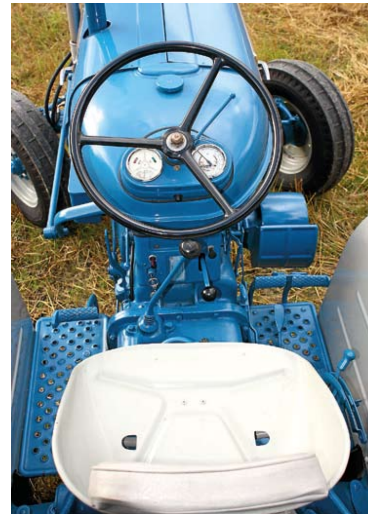
↑ Super Majorin kytkinpolkimien vieressä ovat voimanottoakselin kytkentävipu ja startti. Mittaritaulun yhteydessä on käsikaasu ja äänimerkki. Vasemmanpuoleisesta mittarista löytyy öljynpaineen ja laatuksen merkkivalot sekä lämpömittari, oikeanpuoleinen on tuntilaskijalla sekä yhdistetyllä kierrosluvun ja nopeuden mittarilla varustettu yleismittari. Ohjauspyörän alla olevassa paneelissa on yhdistetty virtalukko ja valokatkaisija, jonka yläpuolella on jälkiasennettu vilkkukatkaisija. Paneelin oikeassa reunassa ovat kertojavipu ja sammutin. Perusvaihteiston vaihdevalitsin on laatikon vasemmassa laidassa. Oikealla puolella ovat käsijarruvädit, yhteen lukittavat jarrupolkimet sekä jalkakaasu.
