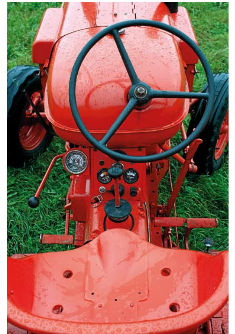
↑ Nuffieldin ohjaamon vasemmassa etukulmassa on jälkiasennettu kertojavipu, ja sen yläpuolella käsikaasu. Mittaritaulun vasemmalla puolella on kierrosluvun, nopeuden ja käyttötunnit näyttävä yleismittari. Varsinaisessa mittaritaulussa vasemmalta katsoen ovat lämpö-, ampeeri- ja öljynpainemittarit. Yläpuolella sammutin, mittarivalo ja valokatkaisija. Alla virtalukko, äänimerkki ja käynnistysnappi. Vaihteiston kannessa on vaihevipu ja öljyn mittatikku. Oikealla puolella ovat kaihtimen säätö, käsijarruvipu, yhteen lukittavat jarrupolkimet ja jalkakaasu.
