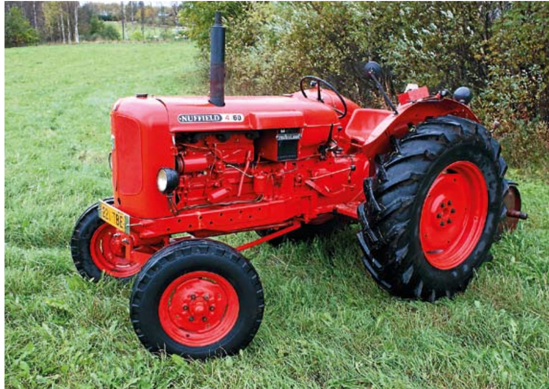
↑ Ensimmäiset Nuffieldit valmistuivat vuonna 1948. Perusrakenne pysyi samana aina vuoteen 1969 saakka, jolloin valmistuivat viimeiset Nuffieldit. Melko pitkälle samoilla piirustuksilla valmistettiin myös Leyland-traktorit, jotka jatkoivat Nuffieldin perinteitä 1980-luvun lopulle. Nuffieldin tavaramerkki oli erityisen järeä runko, joka mahdollisti traktorin käytön mm. kaivurialustana. Vuosina 1961–1964 valmistettu 460-malli oli aikansa tehokkain brittitractori. Nuffieldin tärkein vientimaa oli Suomi.
