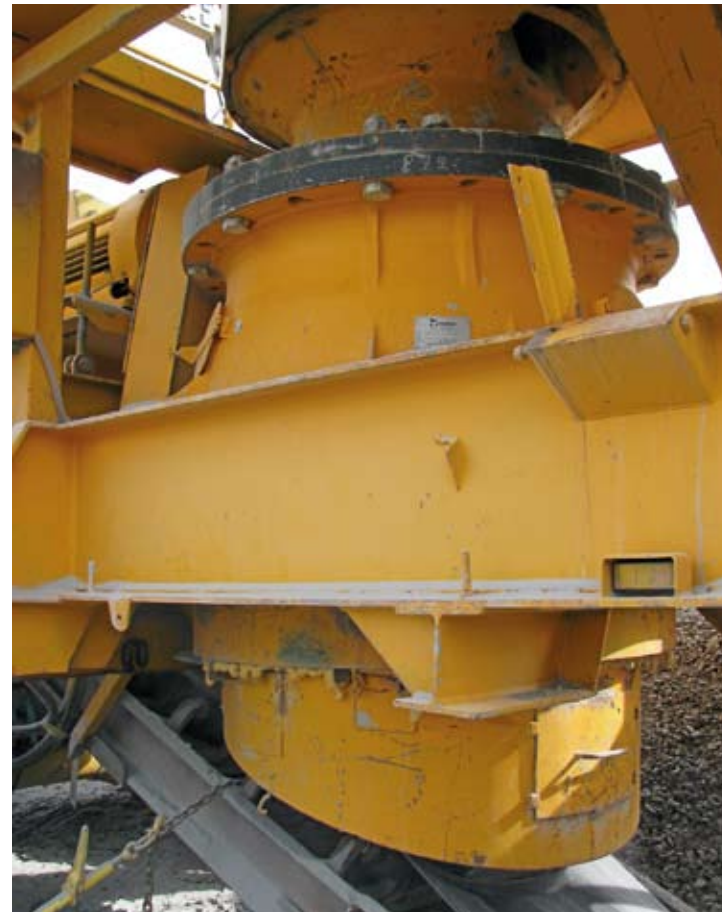
↑ Karamurskaimen voimanlähteenä on 160 kilowatin sähkömoottori, johon sähkö saadaan teholtaan 600 ampeeritunnin aggregaatista.
