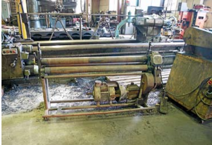
↑ Tämä käsikäyttöinen ”mankeli” on valmistettu omassa pajassa jo kymmeniä vuosia sitten, joskin siihen on myöhemmällä iällä asennettu sähkömoottori ja ”Mersun” vaihdelaatikko. Kone toimii edelleen.
