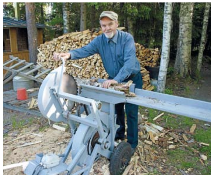
↑ Eino Virtanen on menestyvä konepajayrittäjä ja tunnettu tuotekehittäjä. Tämä klapi-kone on uniikki kappale, jonka hän suunnitteli ja valmisti omaan käyttöönsä. Sirkkelin terä katkaisee puun ja koneen alaosaan kätkeyty halkomaterä pilkkoo sen pieniksi klappeiksi.
