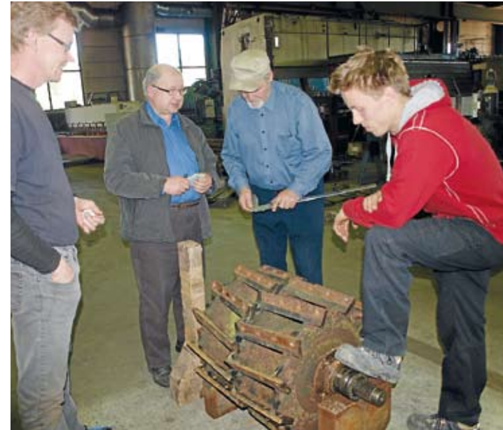
↑ Kolmen maanviljelijän yhteisen Claas-ajoleikkurin roottorin oletettu vika oli akselin vääntyminen, koska vetoremmi ei pysynyt päällä. Uusi roottori ajosilppuriin olisi varaosamyynnissä maksanut 11 500 euroa. Todellinen vika oli kuitenkin akselin katkeaminen. Korjauskustannukset jäivät 20 prosenttiin siitä, mitä uusi roottori olisi tullut maksamaan. Kuvassa viallisen roottorin ympärillä vasemmalta lukien: viljelijä Simo Hortta, markkinointivastaava Mauno Kumpulainen, yrittäjä Eino Virtanen sekä viljelijä Kalle Äijälä.
