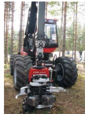
↑ Valmetin 330.2 Duo on energia- ja harvennuspuukourana Valmetin koneilla. Ominaisuudet antavat myös mahdollisuuden järeämpiin puiden kaatoon.
