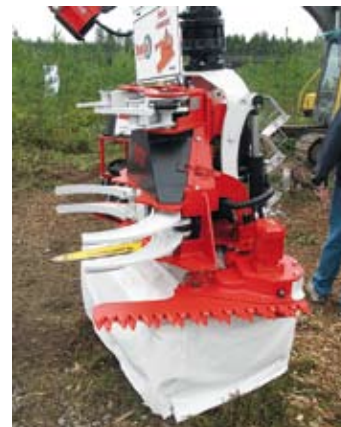
↑ Mense on tuonut markkinoille kouran, jolla voi myös raivata turhat pienpuskat pois. Toimintaperiaate on sama kuin Mensen raivauslaitteessa.
