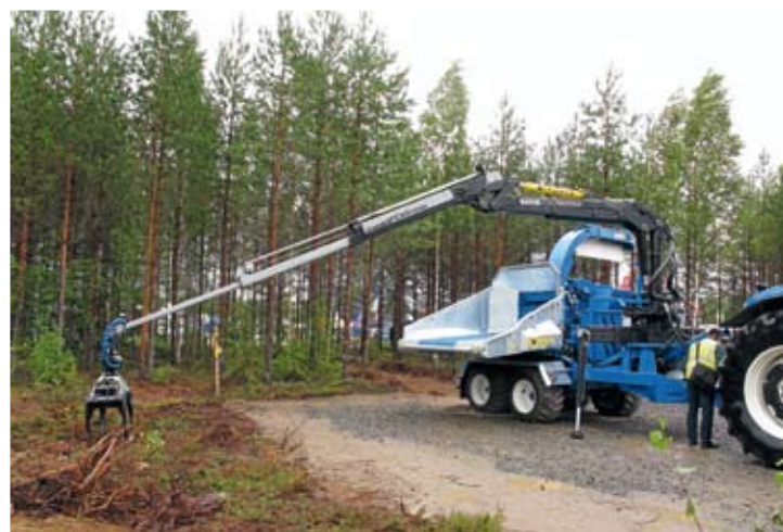
➔ Lapualaiselle Koneurakointi Juha Kankaalle toimitettu Mus-Max Wood Terminator 11 Z on maalattu asiakkaan toivomuksesta peruskoneen sävyiseksi. Hakkurin tehontarpeeksi ilmoitetaan 220–367 kW (300–500 hv), mihin NH 8050:n moottorin pitäisi riittää.
