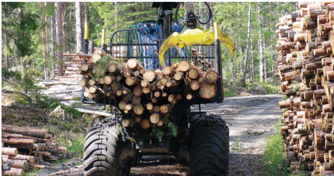
↑ Kuormatraktorilla punnitus tehdään yleensä kuormaa purettaessa.
