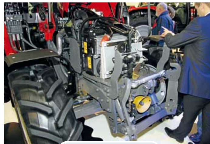
Valmistajan mukaan huolto-kohteisiin pääsee hyvin käsiksi, vaikka koneessa olisi etukuormain paikallaan. Konepelti nousee yhdessä osassa paljastaen tärkeimmät huolto- ja puhdistuskohteet.
