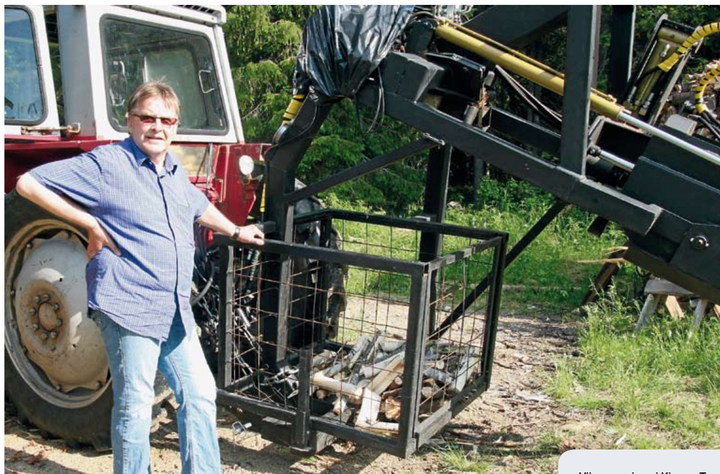
↑ Puut saapuvat halkaisuterälle aina oikeaa yläreunaa pitkin. Näin pienemmät puut halkeavat vain keskeltä.
