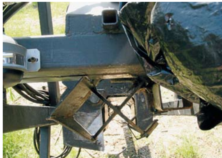
↑ Puut saapuvat halkaisuterälle aina oikeaa yläreunaa pitkin. Näin pienemmät puut halkeavat vain keskeltä.
