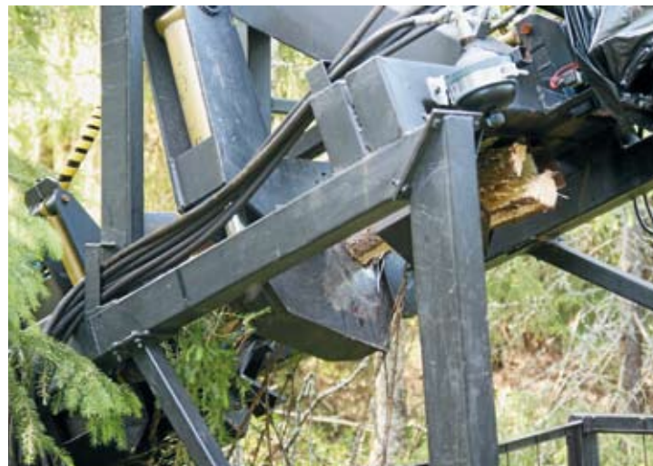
↑ Leikkuuterä pureutuu karsittavaan runkoon ja pitää tukevasti kiinni siitä karsinnan sekä samanaikaisen tapahtuvan halkaisun aikana.
