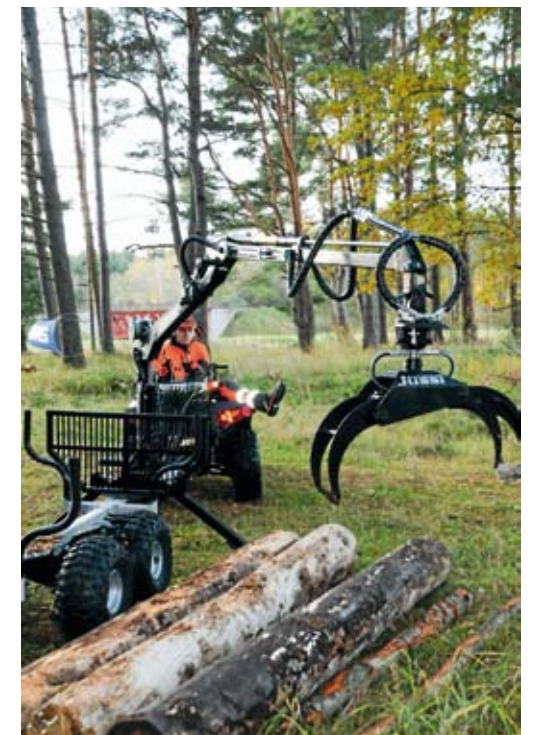
↑ Vahva-Jussiin saa nyt 80-senttisen jatkopuo-min, jonka voi asentaa myös vanhempiin mal-leihin.
