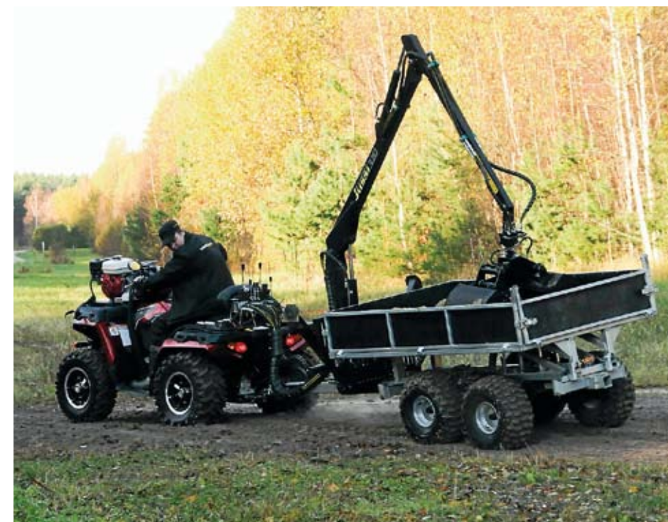
↑ Vahva-Jussin kippiperävaunu ja kahmarikoura kuormaajaan.
