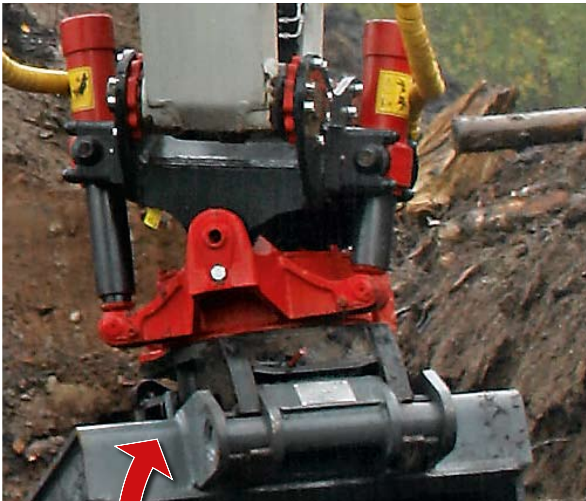
↑ Kauhankallistajan ja -pyörittäjän merkitys korostuu, kun työskennellään tarkkuutta vaativissa ja ahtaissa työkohteissa.
