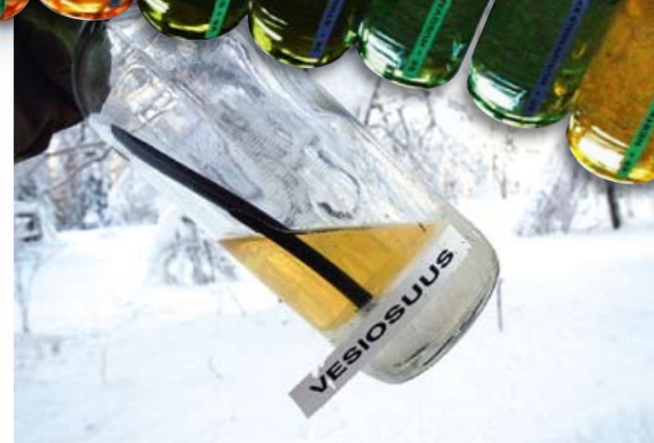
↑ Viinabensa ei toimi kuten jäänestoaineet. Pakkasella vesi on jäässä ja erittäin kiinteässä olomuodossa. Huolimatta korkissa olleesta hengitysreikästä, 95E10 ei houkutellut lisää vettä pulloon.
