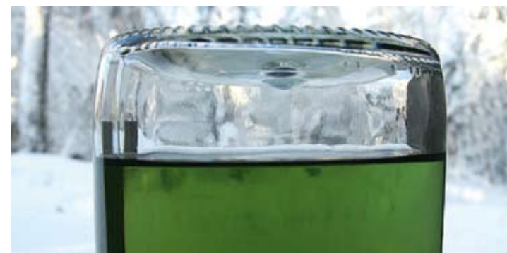
↑ Kun yli puoli vuotta seisoneet seospullost käännettiin varoen ylösalaisin, ei pullon pohjiin havaittu tarttuneen öljyä. Pohjasta putoilleet pisarat olivat kirkkaita ja notkeita. Pulloissa ei näkynyt myöskään mitään erikseen liikkuvaa väreilevää seososaa. Raju ravistelu ei erottanut mitään sakkaa pullon pohjalta.
