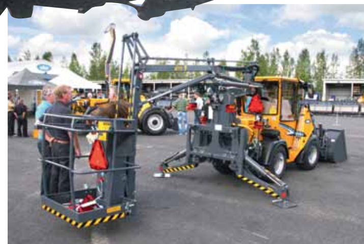
↑ Wille 9 -henkilönostimella nousee lähes yhdeksän metrin korkeuteen. Sivuluottuma on parantunut 5,7 metriin.
