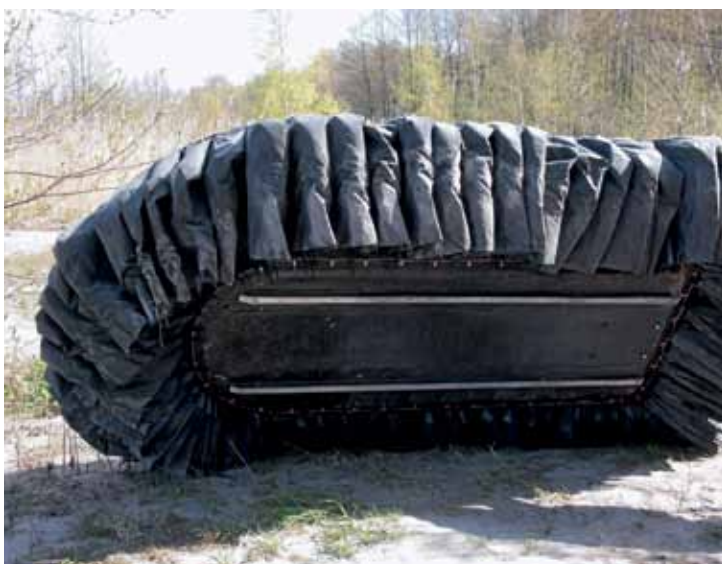
↑ Tasapohjaisen kelluvan rungon alla on kaksi metallikiskoa, joiden varassa alus lepää kovalla alustalla.
