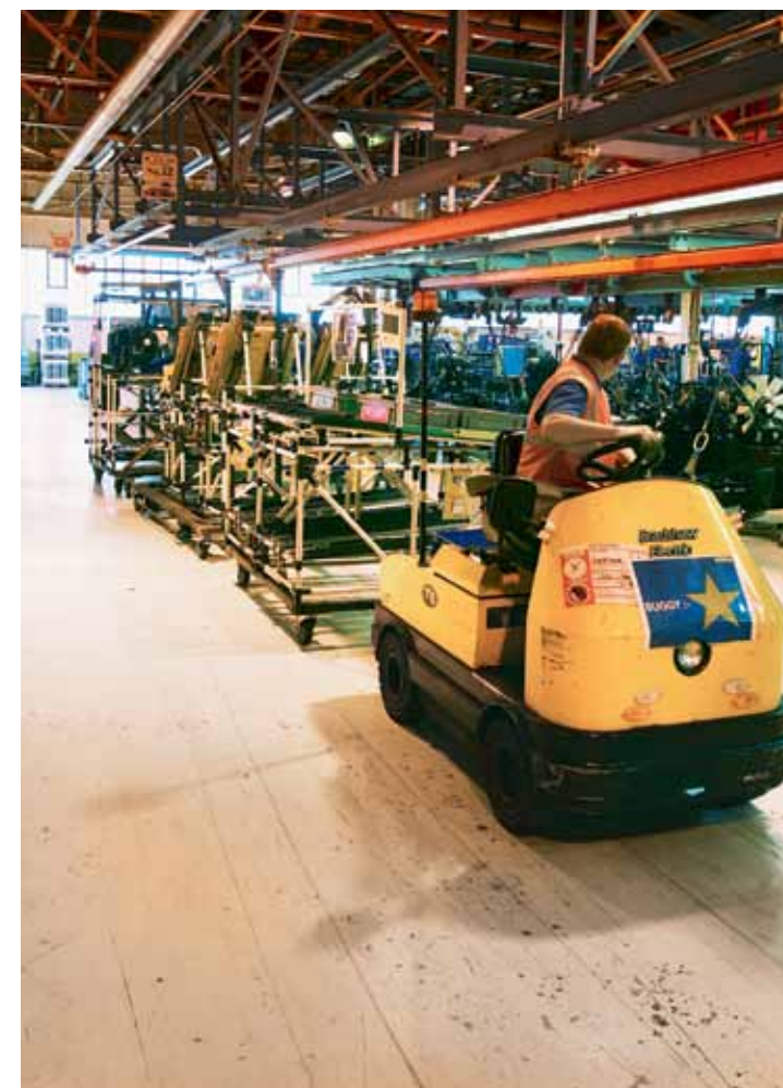
↑ Komponentit tuodaan linjalle pienten sähköveturien vetämillä rullakoilla.
