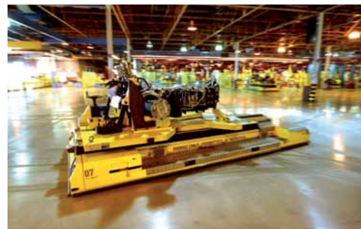
↑ Valmistuslinjan alkupäässä sekä voimansiirrot (kuvassa) että moottorit matkaavat automaattisesti liikkuvien vihivaunujen kyydissä.
