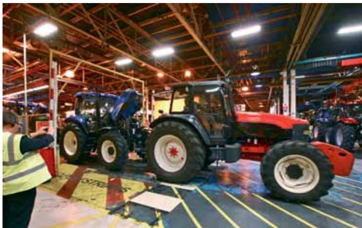
↑ Valmista traktoria ei käynnistetä linjan päässä, se siirretään hinaamalla odottamaan lopputarkastusta.
