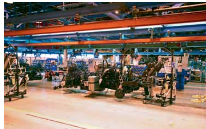
↑ Runko etenee linjalla yläkiskotukseen kiinnittyvien ketjujen varassa.
