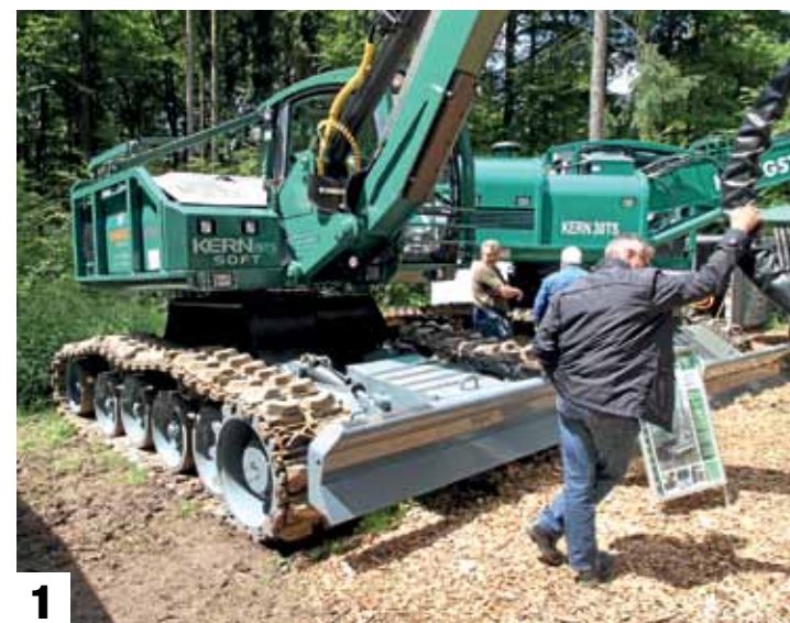
↑ FT Speedy on etunostolaitteen runkoon pikakiinnitettävä tiekarhun korvike. Ketteryyden parantamiseksi runkoa voi kääntää sivusuunnassa.
