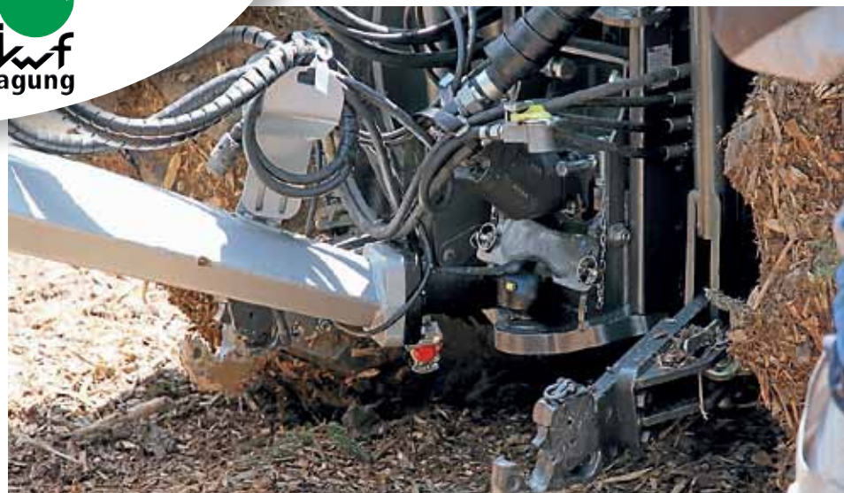
↑ Kuulavetolaite tekee tuloaan myös metsäperävaunuin. Lukituksena oli tässä versiossa sokkalukitteinen järeä tukilevy.
