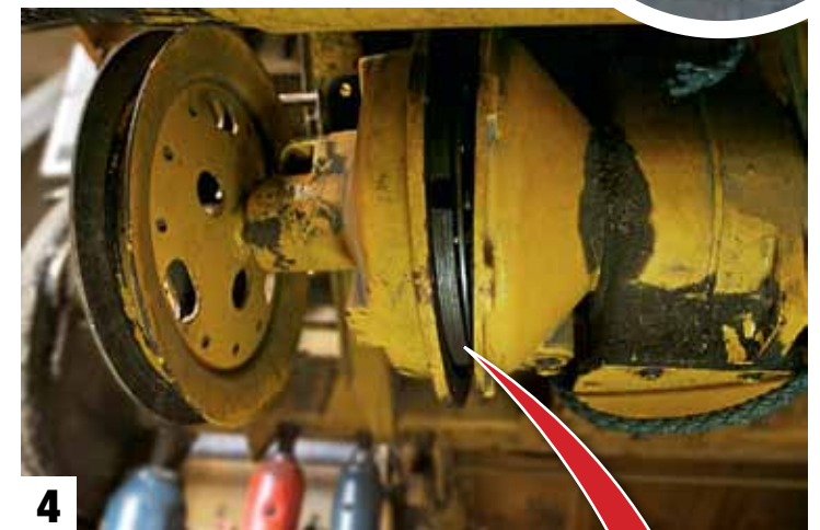
↑ Ei hätää, halkaistun kytkinkopan välistä sopii hyvin avaamaan kytkinasetelman kiinnityspultit, jolloin koppa hihnapyörineen mahtuukin jo sujahtamaan vapaaksi.
