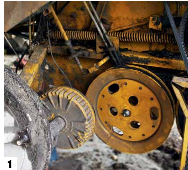
↑ Hyvin alkanut remontti pysähtyy lujasti kiinni juuttuneeseen hihnapyörään. Hyväkään 3-sakarainen ulosvetäjä ei auta.
