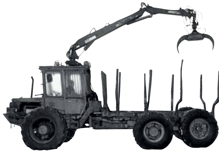
↑ Kun portaalityyppiset vetopyörästöt ovat pystyasennossa, maavaraa on ajalle ruhtinaallisen paljon koko rungon matkalla.
