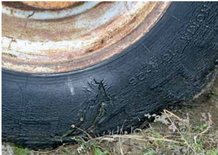
↑ Useat konevalmistajat käyttivät maansiirtokoneiden louhosrenkaita, mutta Valmetissa oli harvinaisemmat nailonvahvisteiset 18.4 x 26 -renkaat. Kantoihin osuessa kudokset katkesivat helposti, jolloin edessä oli rengasremontti. "Ei siihen aikaan edes haaveiltu mistään teräspistosuojauksesta", Eero Rasi sanoo.
