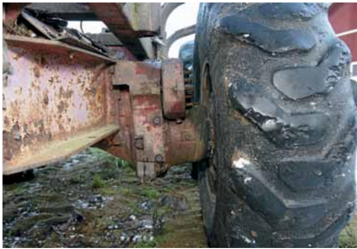
↑ Pyörän vieressä sijaitsevat jarrut ovat perintöä Valmetin maataloustraktoreista. Kuivat levyjarrut likaantuivat ja oli "siivottava kahdesti vuodessa".
