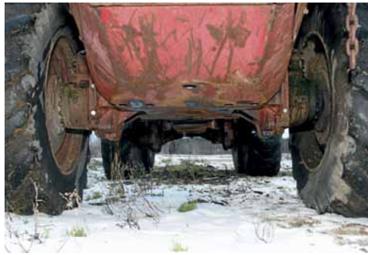
↑ Kun portaalityyppiset vetopyörästöt ovat pystyasennossa, maavaraa on ajalle ruhtinaallisen paljon koko rungon matkalla.
