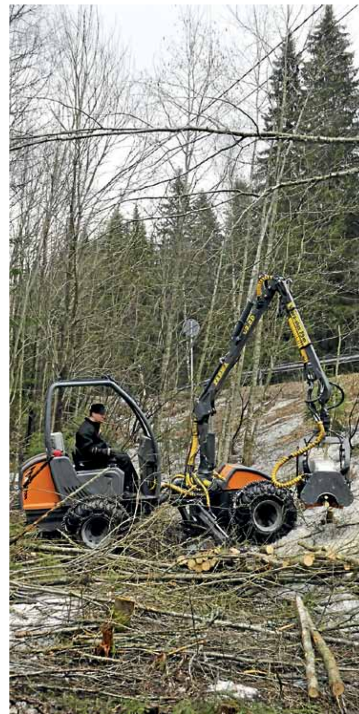
↑ Tehojätkä Eco on nelipyöräinen, edullisempi versio isäntälän koneeksi. Koneessa on kiinni 180S-hakkuupää jossa on saha-katkaisu ja rullasyöttö.
