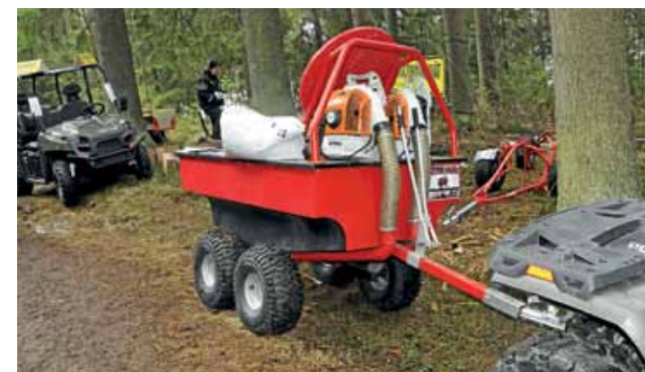
↑ ATV Expertin valmistama metsänlannoitusvaunu on saanut tehokkaammat puhaltimet ja metalliset suutinputket. Levitysleveys on samalla kasvanut.
