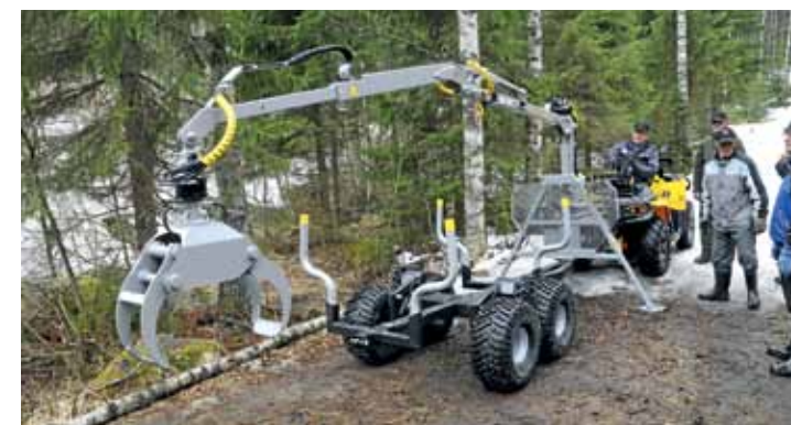
↑ BRP Forest Pro -vaunu on täydellisesti varusteltu, 4,2 metrin kuormaajalla, jossa on veto sekä siirtoteli. Voimanlähde on aisalla.
