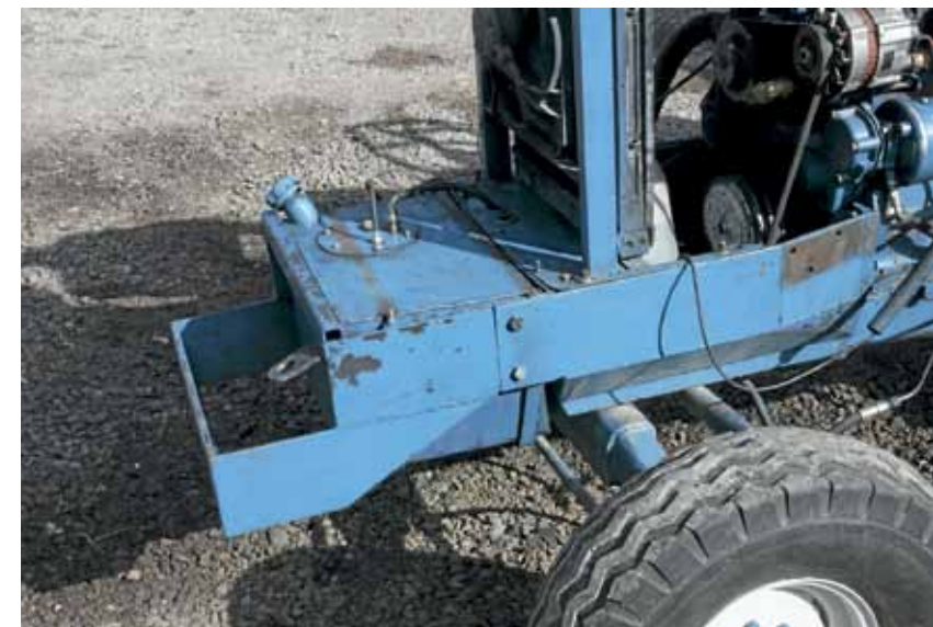
↑ Polttoainetankki on viety vastapainoksi aivan Twisterin keulaan.
