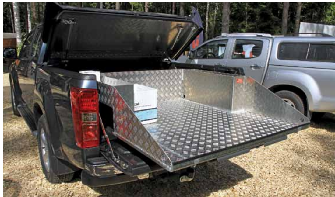
↑ Almeo Svets och Kaross Ab oli varustanut Isuzun avolavan ulos vedettävällä alumiinitasolla, joka suojaavaa lavaa ja helpottaa kuormausta sekä lavan etukulmissa olevien lokerojen käyttöä. Tason veroton hinta on noin 2 000 euron luokkaa. (TH)
