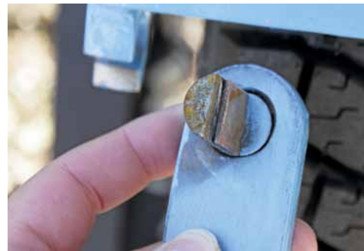
↑ ↑ Telalennkien voitelu kiinteällä voiteluaineella? Kyllä vain, venäläisessä keksinnössä halkaistujen telatappien välissä oleva metalliseos puristuu kitkan kuumentavan vaikutuksen ansiosta vähitellen tapin ja lenkkiosan väliin. Seos muodostaa sinne "muotoonvaletun" liukulaa-kerin. Valmistajan mukaan koekäytöillä 6 000 tunnin käytön jälkeen oli osien kuluma vain 1,5 millimetriä. (TH)
