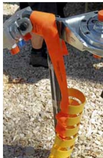
↑ Strap-Wrap on patentoitu idea letkuspiraalien kiinnitykseen. Hihna kietoutuu kolmeen ympäälle kierrokseen ja sallii niille hieman joustoa. Samalla se estää liiallisen oikeneimen. Hihnan toisessa päässä on lenkki, josta hihna voidaan kiinnittää puomistoon. (TH)
