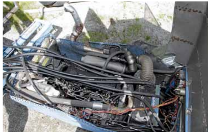
↑ Clion oma ohjauksentehostimen venttiilikko ohjaa kääntösylinterin hydrauliliikaa. Käytön kannalta hankalaa ovat pitkät kaas- ja vaihteensiirtovaijerit, jotka takertelevat ja ovat hieman epätarkkoja.
