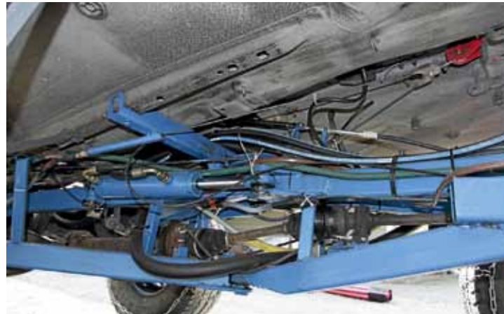
↑ Clion oma ohjauksentehostimen venttiilikko ohjaa kääntösylinterin hydrauliliikaa. Käytön kannalta hankalaa ovat pitkät kaas- ja vaihteensiirtovaijerit, jotka takertelevat ja ovat hieman epätarkkoja.
