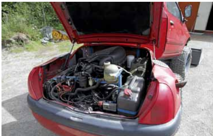
↑ Kuormain hyödyntää suurelta osin Clion omaa tekniikkaa. Moottori on 1,9 litrainen diesel. Perät ovat kuitenkin Ford Cosworthista ja hydraulipumppu Valmetista.
