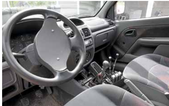
↑ Puomi liikutetaan apukuskin jalkatilaan sijoitetuilla vivuilla. Muuten ohjaamo on kuin alkuperäisestä Cliosta.
