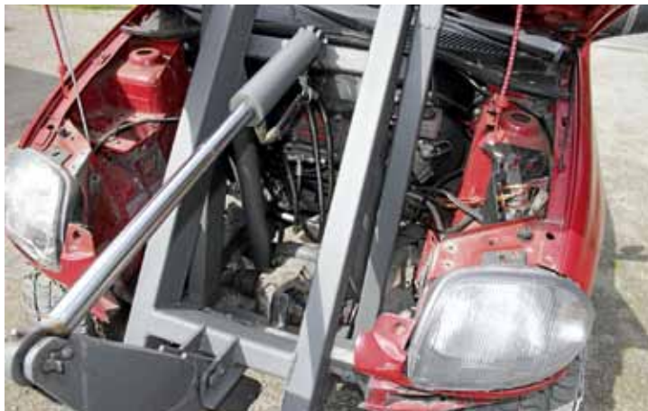
↑ Z-puomiston suunnittelussa rakentaja hyödynsi pahvista pienoismallia, jolla hän kokeili sopivat mittasuhteet. Puomisto on tuettu etuakselin tukirakenteisiin.
