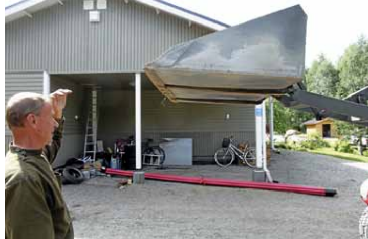
↑ Kuormaimen kauha kiinnitetään trukkipiikkien päälle. Piikkien kärjet sopivat kauhan etuosan taskuihin. Ylhäältä kiinnitys tapahtuu pikalukoilla.
