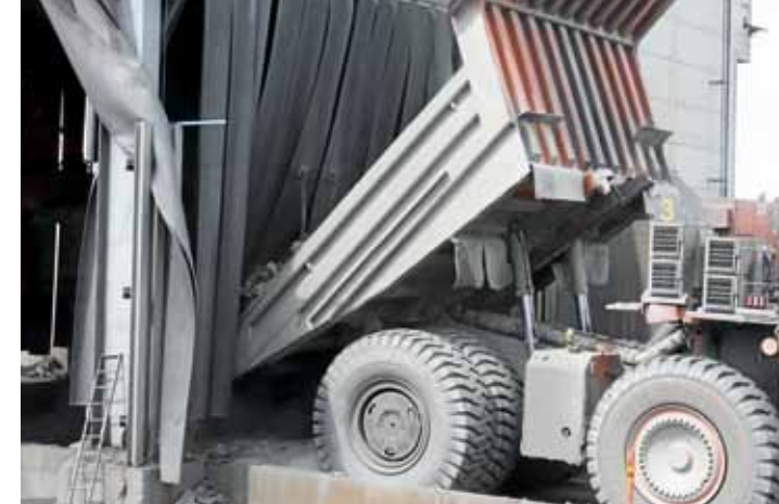
↑ Talvivaarassa ajellaan 160–170 tonnin lasteilla, mikä tarkoittaa n. 320 tonnin kokonaispainoa. 40 tonnin kauhallisen pudottaminen lavalle ei autoa vielä paljoa hytkäytä, mutta kun täysi lasti putoaa murskaimelle, tuntee sen ohjaamossa hyvin selvästi.
