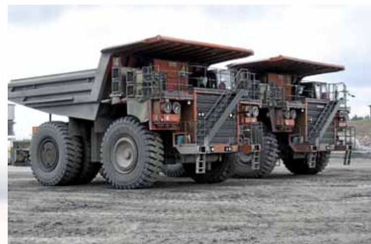
↑ Kivet ajetaan louhokselta murskaimelle kahdeksalla Hitachi EH3500 -louheautolla. Mitat ovat mykistäviä, pituus 12,24 m, leveys 8,12 m, korkeus 6,37 m ja maavara 74 cm. Kipattaessa lavan etulaita nousee lähes 13 metriin.
