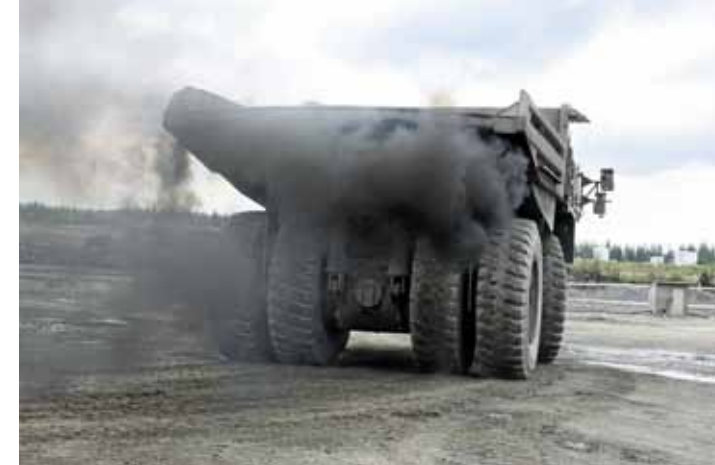
↑ 12-sylinterinen 50:n litran Detroit Diesel tarvitsee 2 000 hv:n kehittä- miseen runsaasti evästä. Keskikulutus on 110 litraa tunnissa, tiukassa paikassa saattaa palaa jopa 250 litraa. Tyhjäkäynnillä päästään alle 10 litraan. Auton hallinta on kokonaan tietokonepohjaista, järjestelmiä on 3.
