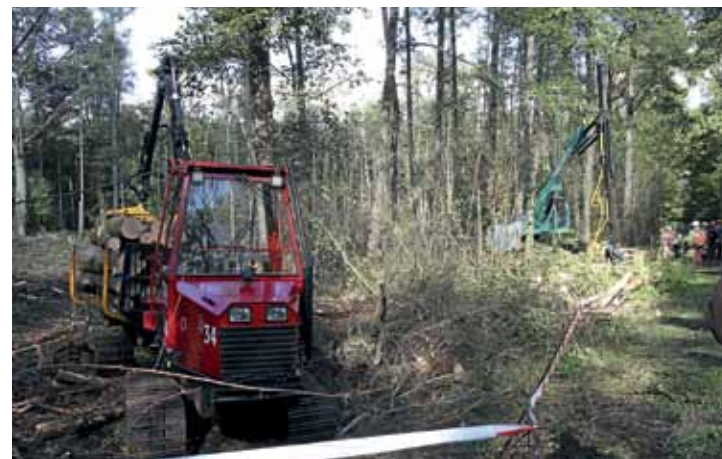
↑ ↑ ”Daavidin ja Goljatin” kohtaaminen oli esimerkki ennakkoluulottomasta lähestymistavasta. 27 tonnia painavan, 16 metrin päähän ulottuvan ja 4,5 metriseksi levenevän Königstiger T 25:n hakkaamat rungot ajettiin Terri 34 -telakuormatraktorilla. Koska hakkuu-ulottuma oli erittäin pitkä, kertyi urille molemmilta puolilta hakaten valtava määrä oksia ja latvuksia.
