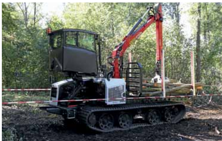
↑ Yksi varsin mielenkiintoinen idea oli teladumpperin valjastaminen kuormatraktoriksi. Kuorma-auton alumiinipankot ja puutavarakuormain istuvat hyvin alustan päälle. Koska ohjaamossa ei ole tilaa kääntymiselle, oli siitä tehty ylösnostettava ja kääntyvä.
