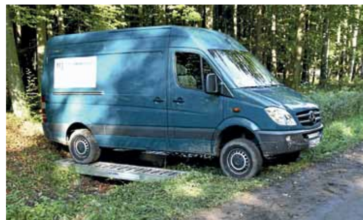
↑ Jos liittymää ei ole, se tehdään. Järeät alumiiniset rampit mahdollistavat huoltoauton sijoittamisen aivan palstan lähelle.
