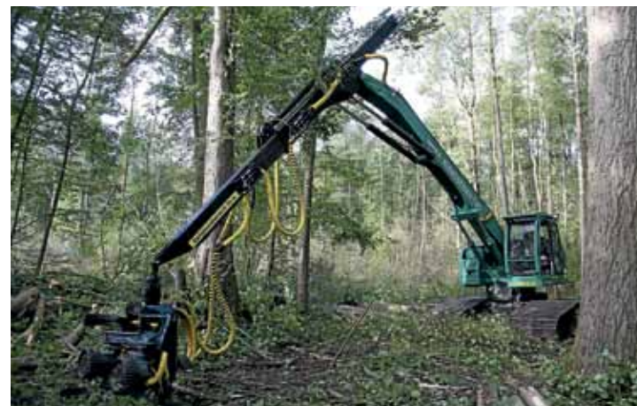
↑ ↑ ”Daavidin ja Goljatin” kohtaaminen oli esimerkki ennakkoluulottomasta lähestymistavasta. 27 tonnia painavan, 16 metrin päähän ulottuvan ja 4,5 metriseksi levenevän Königstiger T 25:n hakkaamat rungot ajettiin Terri 34 -telakuormatraktorilla. Koska hakkuu-ulottuma oli erittäin pitkä, kertyi urille molemmilta puolilta hakaten valtava määrä oksia ja latvuksia.
