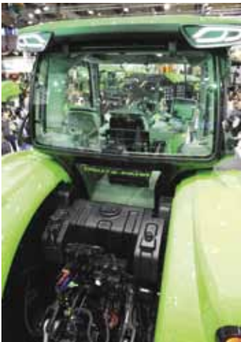
↑ Ohjaamo on jousitettu hydraulisesti jokaisesta nurkasta ja lokasuojat ovat kiinni traktorin rungossa eivätkä ohjaamossa muiden traktoreiden tapaan.
