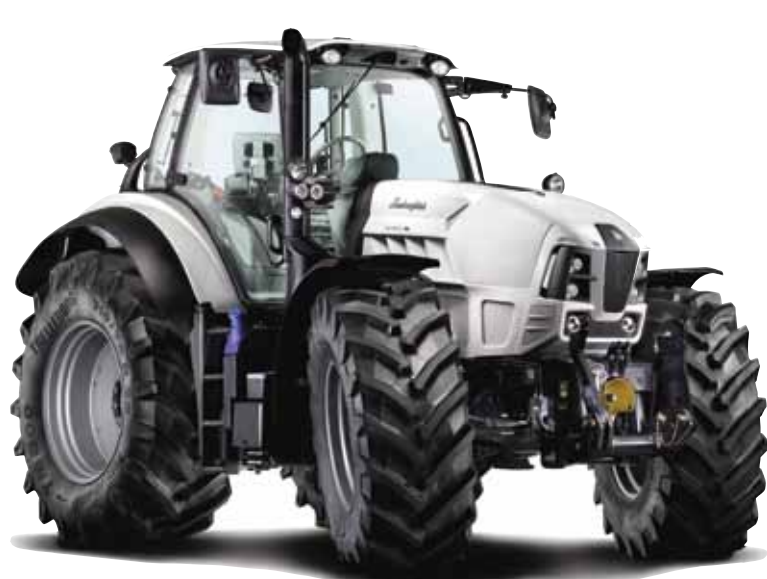
↑ Hopeamitali napsahti myös automaattisesta voiman ulosoton pyörintänopeuden hallinnasta. Järjestelmä toimii yhdessä CVT-voimansiirron kanssa. Se mittaa akselilta otettavan voiman määrää ja muuttaa voiman tarpeen vähentyessä pyörinnän polttoainetta säästävälle ECO-mallille.
