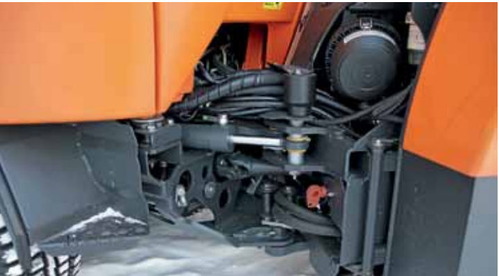
↑ Runko-ohjaus, matala rakenne ja monipuolinen hydraulikka ovat niitä tekijöitä, joiden seurauksena testin koneet ovat omiaan aiheuttamaan huollon henkilöstölle ylimääräistä stressiä. Vaikka suunnittelijat ovatkin sijoittaneet useimmat rutiinihuoltojen kohteet, kuten ilmanpuhdistajan kuvan Holderissa, mukavasti esille, ovat jossain vaiheessa eteen tulevat letkuremontit varmasti työläitä.
