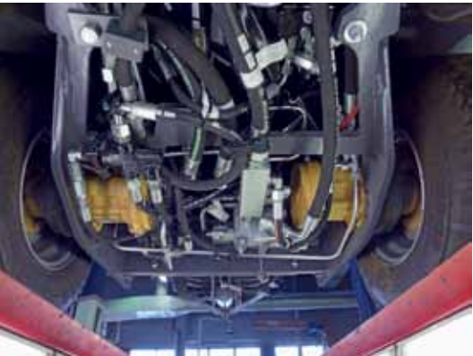
↑ LM Tracin pohja oli täysin vailla suojausta. Koskeus ja talviset suolariskeet käynnistävät vääjäämättä korroosion. Vaikka ruostuminen ei hydrauliliikkaa suoraan häiritse, vaikeuttaa se letkujen vaihtoja ja muita korjaustöitä.
