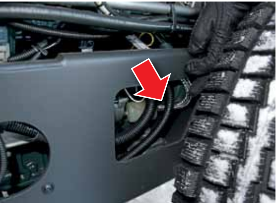
↑ Holderin Kubota-moottorin öljynsuodatin on erittäin ikävässä paikassa. Metallinväriinen polttoaineletku ja siinä oleva lisäsuodatin viimeistelevät tämän huoltokohteen hankaluuden. Monet muutkin moottorin varusteista jäävät ikävästi runkopalkkien tai letkujen katveeseen.
