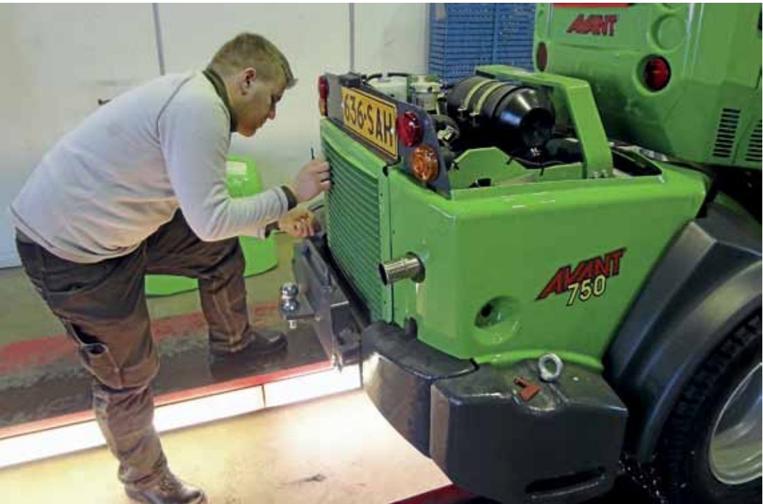
↑ Avantin konetilaa ympäröivät suoja-levyt on kiinnitetty pienillä ruuveilla, jotka varsinkin talvella putoavat ja hukuvat herkästi. Kuitenkin esimerkiksi pääsy akun luokse vaatii kahden suojuksen irti ruuvaamisen.
