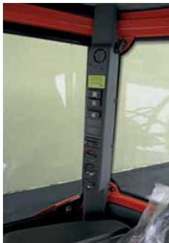
↑ Holderin yleisimminkin käytetyt katkaisijat on sijoitettu käden ulottuville ohjaussauvan viereen, mutta harvemmin tarvittavat nappulat löytyvät takapilarista.
