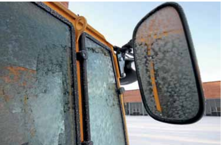
↑ Testikoneista ainoastaan Wilestä löytyi lämmitettävät peilit. Yleisesti ottaen pikkukoneiden ohjaamoista oli hyvä näkyvyys.
