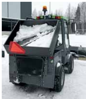
↑ LM Tracin hintaan kuuluu kippilava. Valitettavasti takalaidan sarakkeita mukana ei tule, vaan lavan tyhjentäminen pitää tehdä käsin tai irrottamalla laita avamalla kuusi pulttia.
