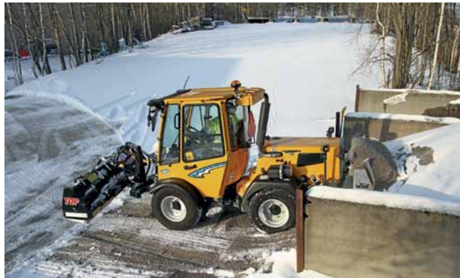
↑ Willen takanostolaitteeseen kiinnitettävän hiekoittimen saa täytettyä suoraan sepelikasasta. Tyhjentäminen tosin onnistuu ainoastaan hiekoittimen läpi pyörittämällä.
