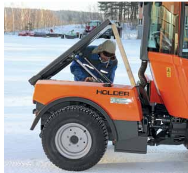
↑ Holder ja LM Trac varustetaan hydraulisella kippilavalla. Huoltotöiden ajaksi ohjekirja kehottaa tukemaan lavan pönkällä, jota ei koneiden mukana kuitenkaan toimiteta.
