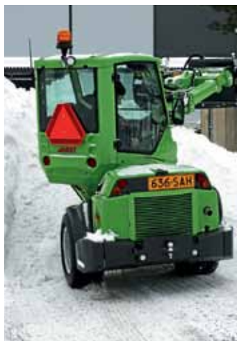
↑ Tiukoissa käännöksissä Avantin ohjaamo kiertää noin 20 cm rengaslinjan ulkopuolella, mikä pitää ottaa huomioon esimerkiksi kaiteiden läheisyydessä.
