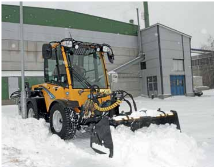
↑ Testikoneet olivat 120–137 cm leveitä, joten niillä mahtuu auraamaan kapeistakin tolppaväleistä.
