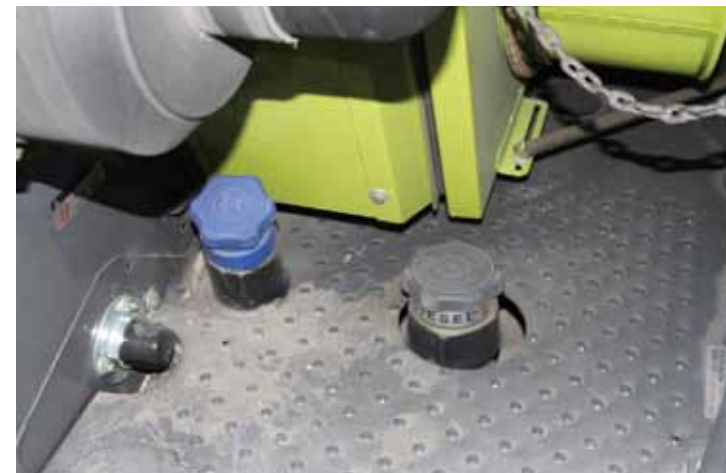
↑ Claas Tucano -puimurissa urean täyttökorkki on korkealla. Erehtymisen vaaraa vähentää urean täyttökorkin sininen väri.
