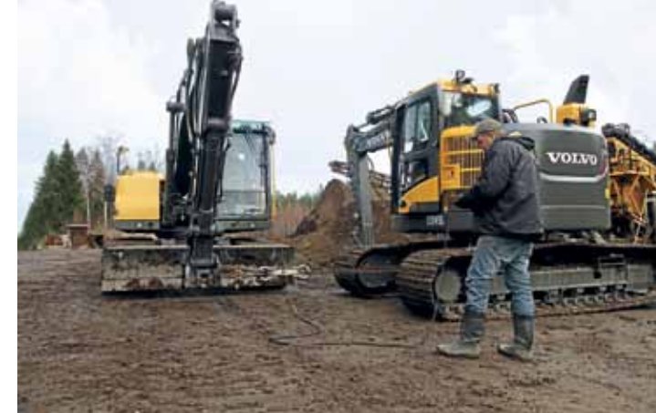
↑ Koneiden voimatasot ovat nostokykyä lukuunottamatta samat. Erot nostovoimassa selittyvät erilaisella puomin kiinnityksellä.
