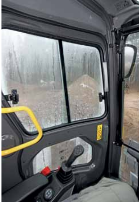
↑ Näkyvyys vasemmalle on lyhytperäisessä Volvossa rajoittunut, sillä matala ja yhtenäisen liukuovi rajoittaa näkymää.
