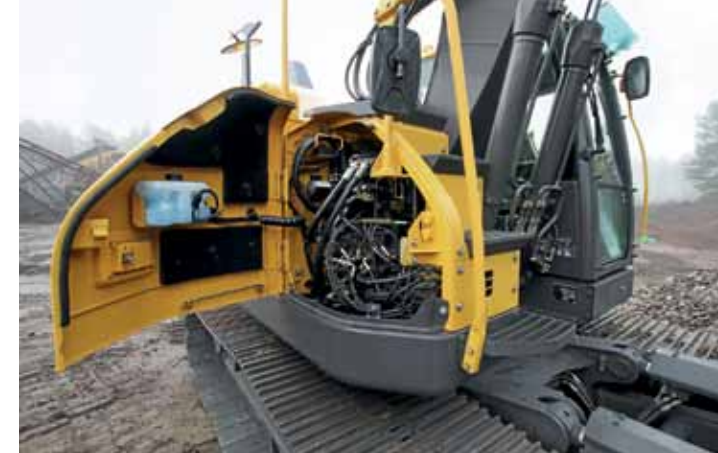
↑ Lyhytperäisen koneen etukulmassa on tiiviisti pakattu venttiililohko ja tankkauspumppu.
