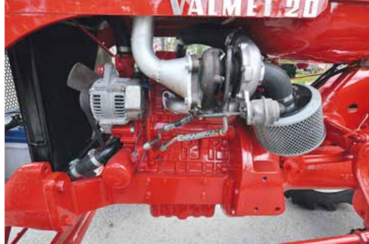
↑ Muutoksessa traktorin paino ei noussut, koska nykyaikainen dieselmoottori on bensakonetta kevyempi.
