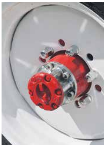
↑ Etunavoista voi irrottaa etuvetoa pois päältä.
