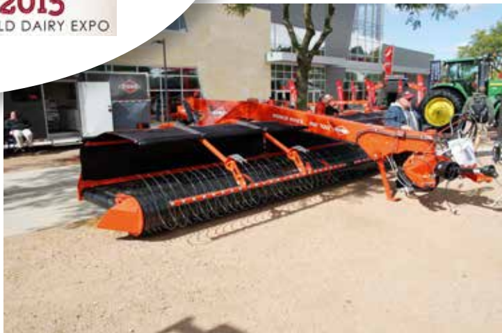
↑ Kuhnin MM Merge Maxx 700 -karhotin toimii noukinperiaatteella, jolloin esimerkiksi sinimailasen varisemistappiot pysyvät karhottaessa kurissa. Koneen työleveys on 7,26 metriä. Saatavilla oli myös pienempi MM 300 ja suurempi MM 902 -malli.
