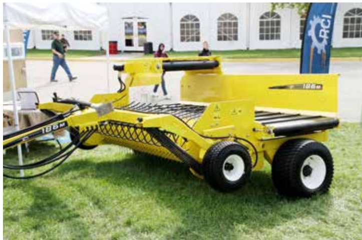
↑ RCI Engineering valmistaa 186M-karhotinta, joka perustuu niin ikään noukkimeen ja mattokuljettimeen. Tekniikka pyrkii minimoimaan maan kulkeutumisen rehuun karhotuksen yhteydessä. Koneen työleveys on 2,6 metriä.
