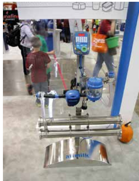
↑ Afimilk Afilab on analysointijärjestelmä maidolle. Maitoputkeen kiinnitettävän mittalaitteen avulla voidaan maidon laatuominaisuuksien määrittämisen lisäksi havaita esimerkiksi ruokintaperäisiä sairauksia, kuten ketoosia.
