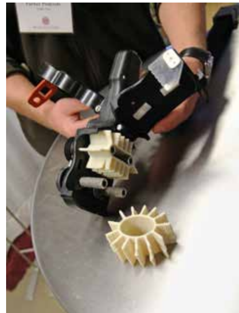
↑ Udder Gun on vedinten esikäsittelyyn tarkoitettu lisälaite lypsyasemalle. Paineilmatoimiset kumisiivekkeet puhdistavat vetimen ja samalla voidaan käyttää myös vedinkastoa. Yhdessä järjestelmässä on kaksi "pistoolia".
