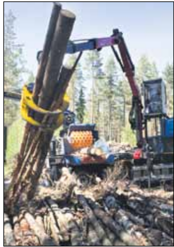
Ruotsalaisvalmisteinen hakkuri nielee ja leikkaa rungot hakkeeksi muutamassa sekunnissa.
