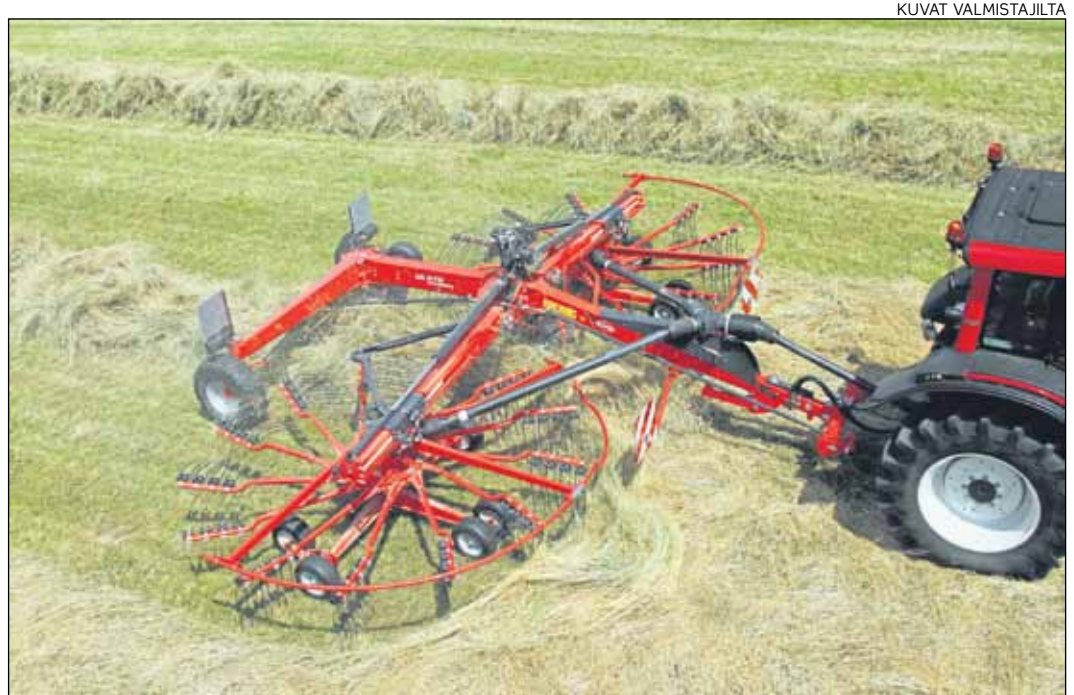
Kuhnin uudella karhottimella kerää heinät 8,5 metrin leveydeltä.
