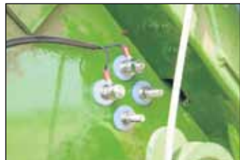
Paalaimeen asennettava kosteusmittari.
