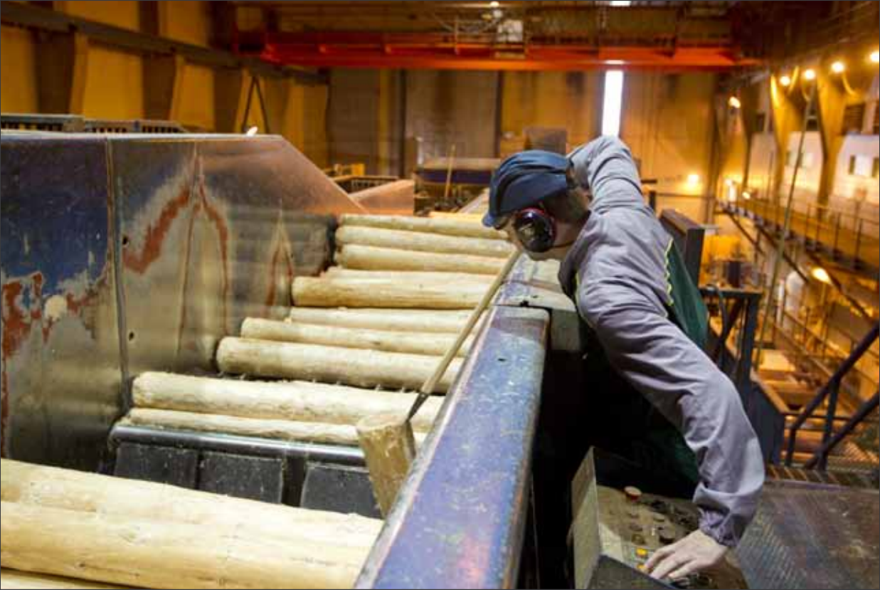
Hiomossa hiotaan kuudesta mekaanista massaa, jolla vähennetään paperin läpinäkyvyyttä. Puu pyritään tuomaan hiomoon kaksi viikkoa kaadosta tai jäisenä. Ari Munne töissä. Paperia syntyy koneella noin yksi rulla eli yli 30 tonnia tunnissa.
