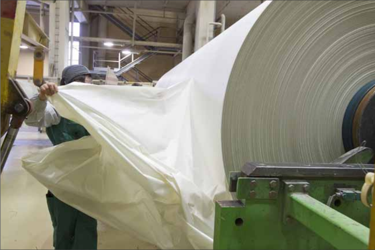
Hiomossa hiotaan kuudesta mekaanista massaa, jolla vähennetään paperin läpinäkyvyyttä. Puu pyritään tuomaan hiomoon kaksi viikkoa kaadosta tai jäisenä. Ari Munne töissä. Paperia syntyy koneella noin yksi rulla eli yli 30 tonnia tunnissa.
