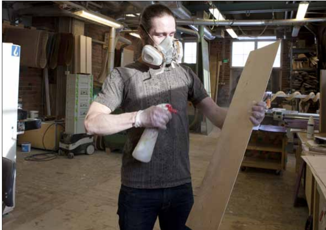
Esa Niiranen liimaa viilukerrosia yhteen pitkittäin ja poikittain.
