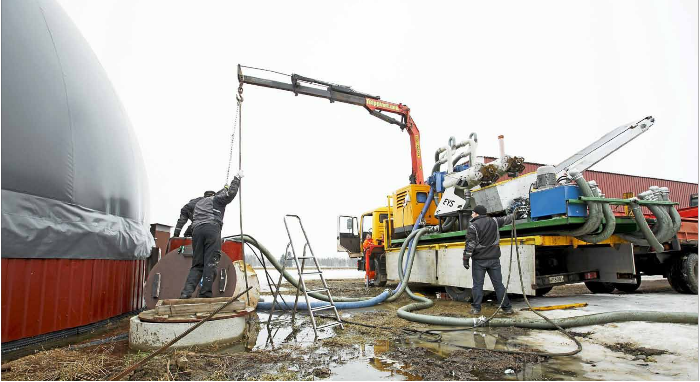
Tero Savela Reiskone Oy:stä ja Heikki Kiljala Rekitec Oy:stä näyttivät viime perjantaina Haapajärven maatalousoppilaitoksella, miten liettestä separoidaan kuiva-aine.
