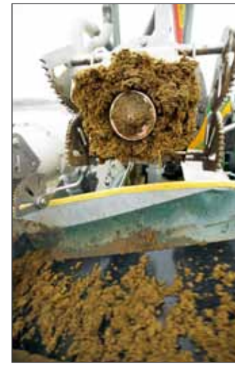
Pumppu nostaa lietteen. Ruuvi työntää kuiva-aineen kuljettimelle, joka siirtää sen eteenpäin.
