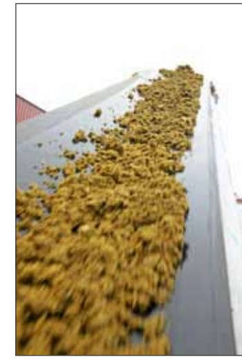
Pumppu nostaa lietteen. Ruuvi työntää kuiva-aineen kuljettimelle, joka siirtää sen eteenpäin.
