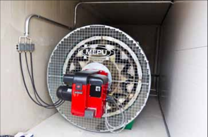
Alipaineuunissa ilma imetään uunin läpi.
