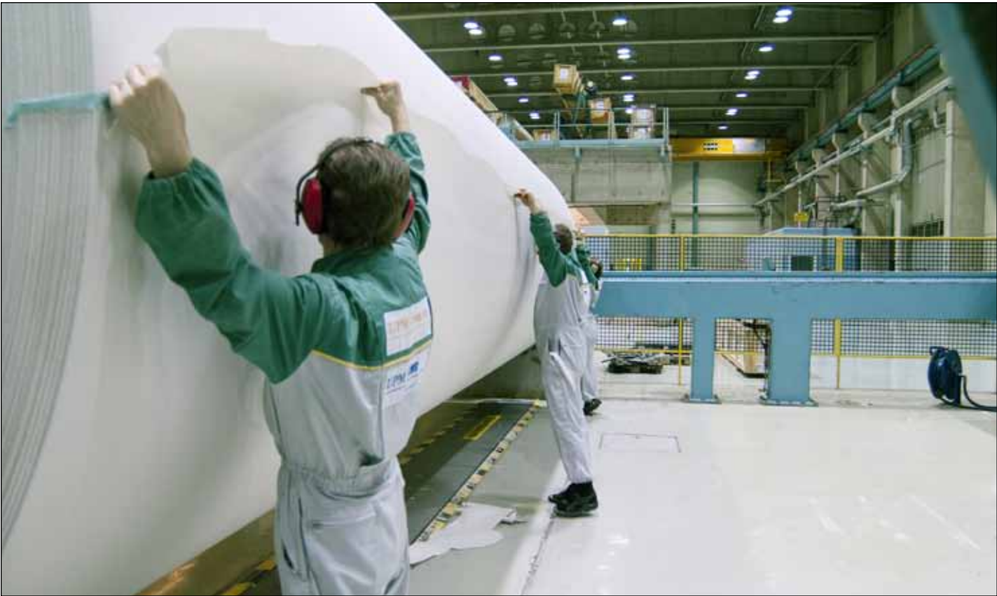
UPM on uudistanut vuonna 1989 aloittanutta PK 7:ää vuosien mittaan. Runsaat kahdeksan metriä leveä kone suoltaa parhaimmillaan paperia reilut puolitoista kilometriä minuutissa.
