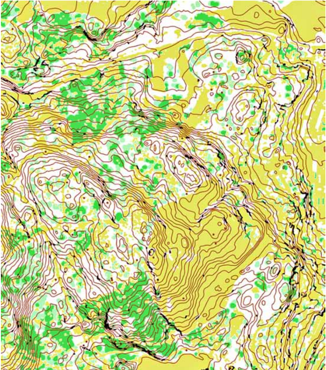
Karttapullautin tuottaa lähes oikean suunnistuskartan veroisia karttoja. Vasemmalla karttapullauttimella tehty ja oikealla tavallinen suunnistuskartta Norjan Torshaugista. Pullauttimella tuotettuun käyrästöön voi lisätä esimerkiksi rakennukset ja tiet muista tietolähteistä.
