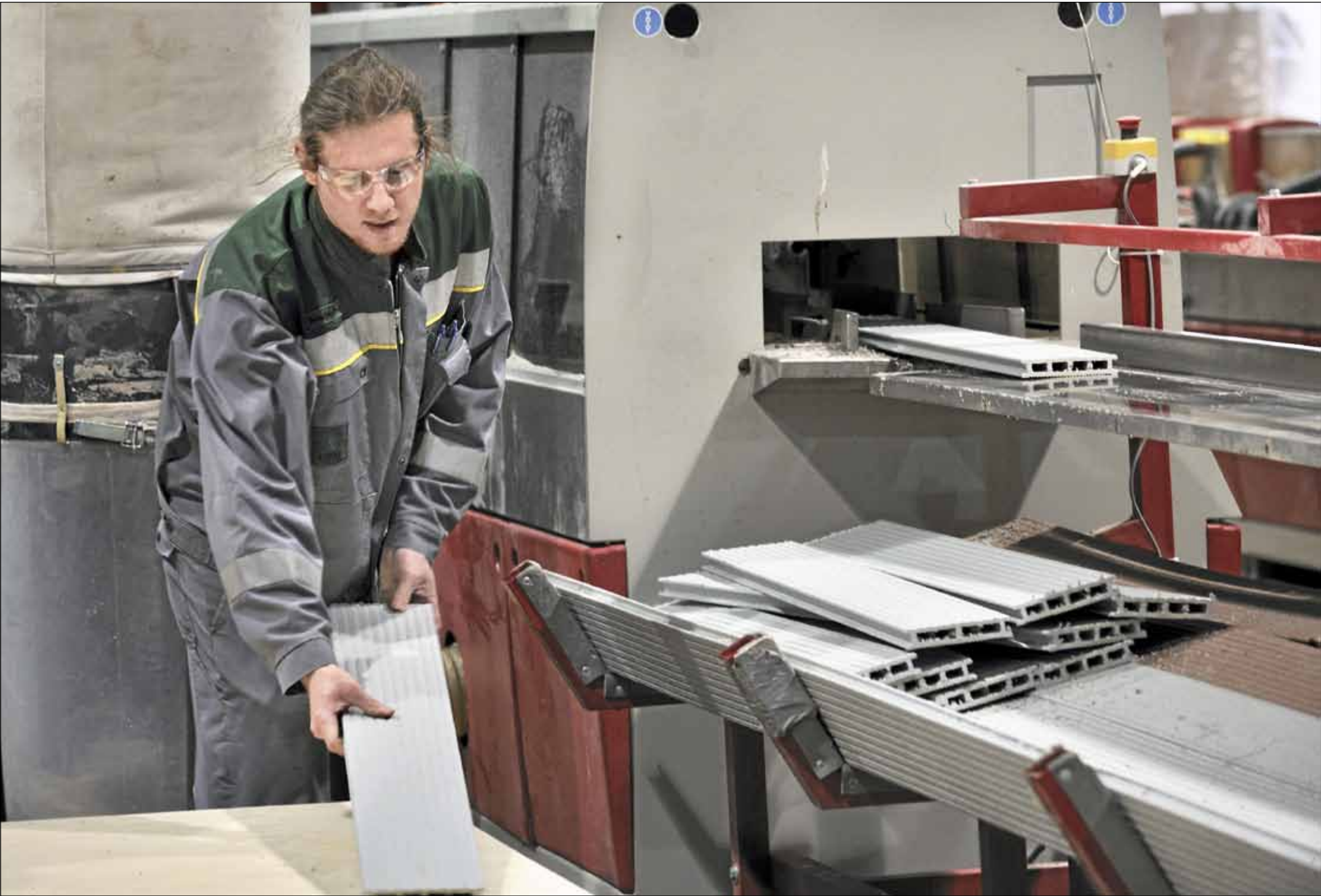
Lahden puumuovitehdas on pitkälle automatisoitu, joten se selviää kevyellä miehityksellä. Maksim Pellja tarkastelee suulakepuristuskoneen sylkemää tuotetta lankkua.
