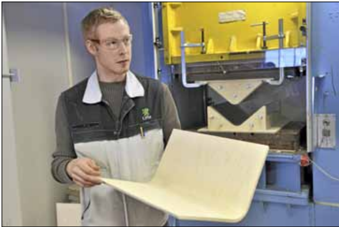
Kuumennettu levy asetetaan muottiin, jossa se jäähtyy ja jäähmettyy uuteen muotoonsa, näyttää Antti Lankinen.
