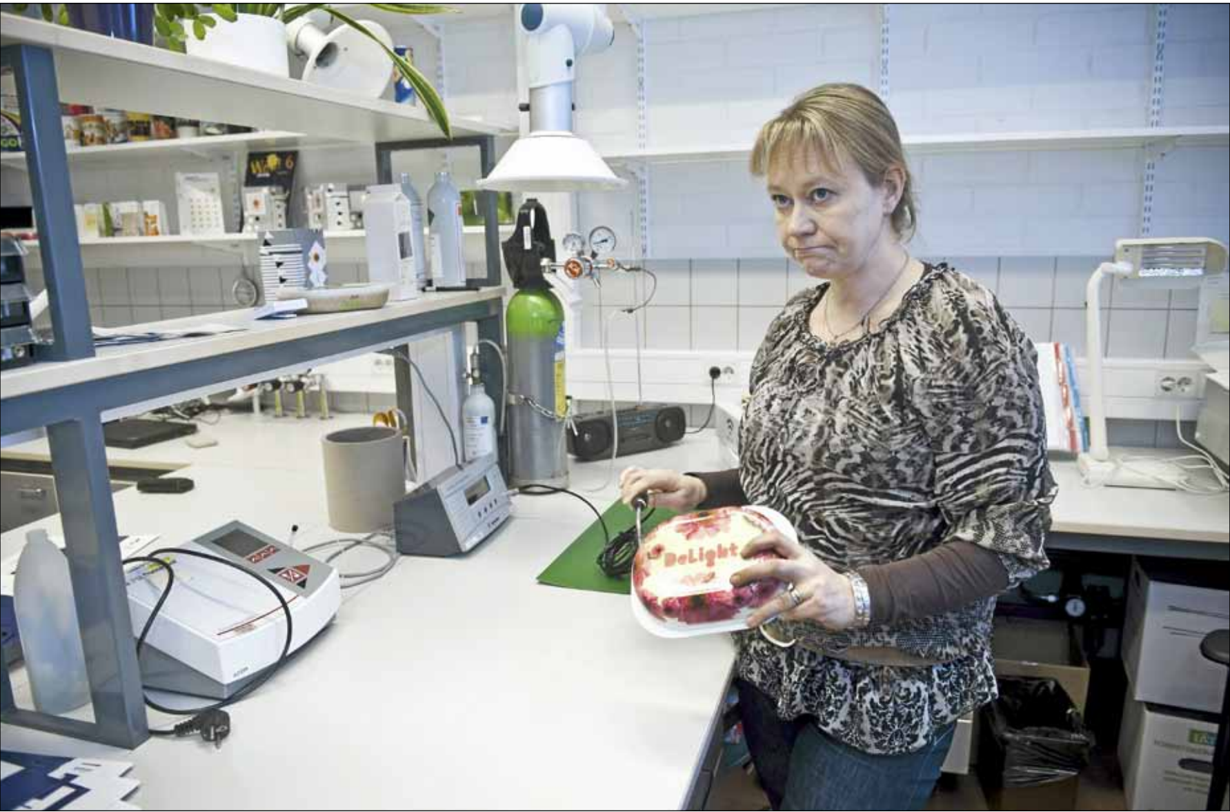
Stora Enson tutkimuskeskuksessa Imatralla kehitetään pakkausmateriaaleja. Projektipäällikkö Mari Hiltunen tutkii kartonkivuokaa vetyanalysaattorilla. Laite löytää kohdan, josta pakkaus vuotaa.
